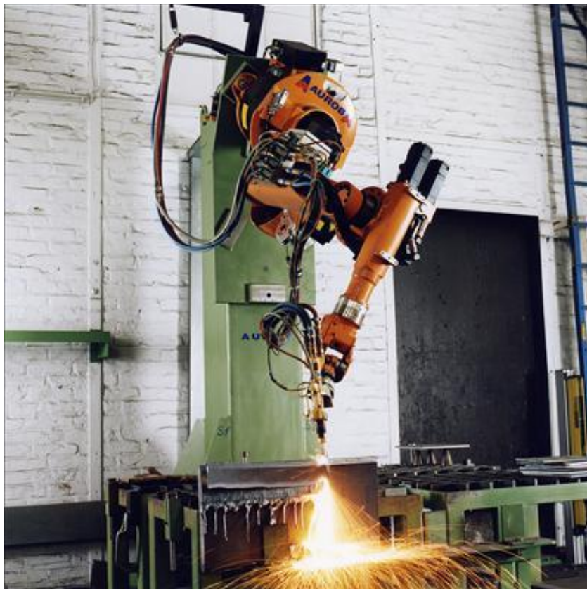
Slika 2-15 Rezanje konstrukcijskih elemenata [26]
