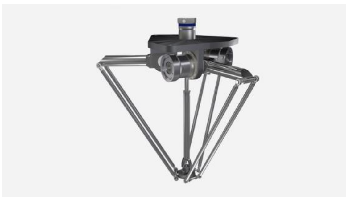
Slika 2-11 Paralelni robot (Delta robot) [22]
