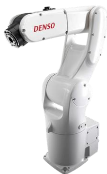
Slika 2-13 Moderni sferični ili polarni robot [24]
