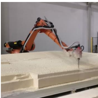
Slika 3-8 Glodanje u brodogradnji [10]
