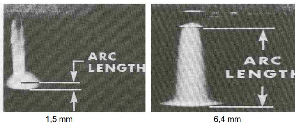
Slika 8.1.5. Usporedba duljine električnog luka (10 A).[43]
