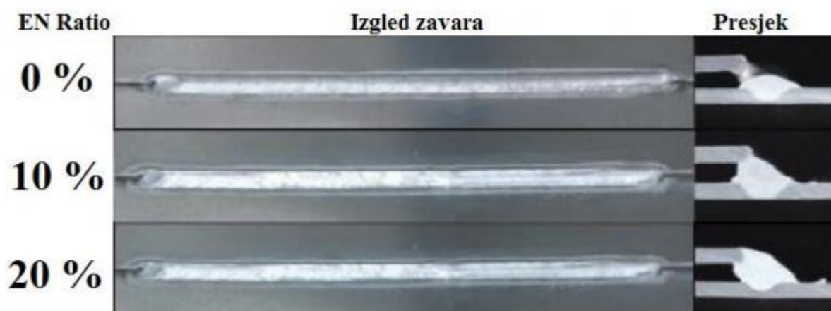
Slika 5.5.1. Utjecaj negativnog polariteta pri spajanju aluminijske legure (AC MIG).[7]
