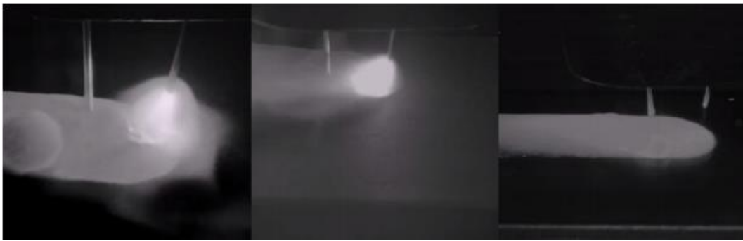
Slika 5.8.1. Realni prikaz prijenosa metala kod tandem zavarivanja.[7]
