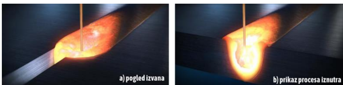
Slika 5.7.1. Prikaz metode zakopanog luka.[23]
