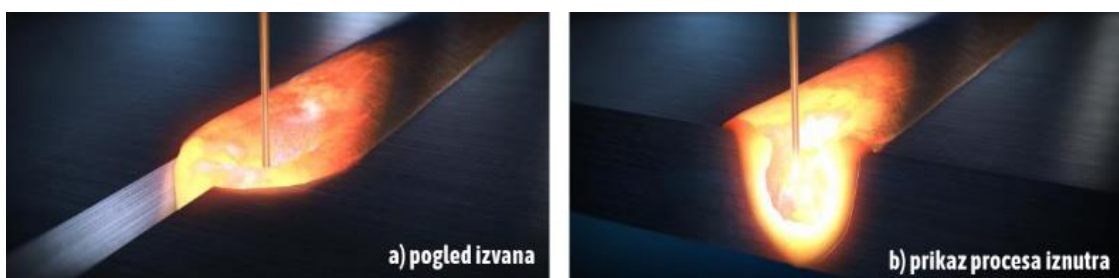
Slika 5.7.1. Prikaz metode zakopanog luka.[23]
