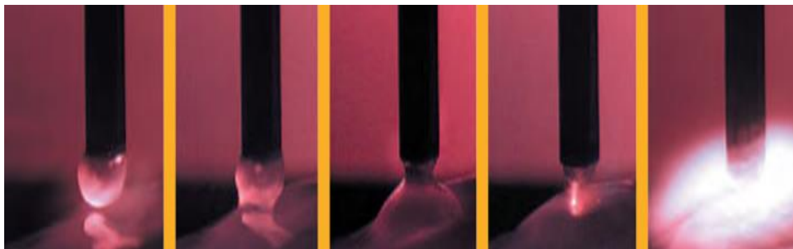
Slika 5.1.1. Prijenos kapljice metala tijekom STT postupka zavarivanja.[17]
