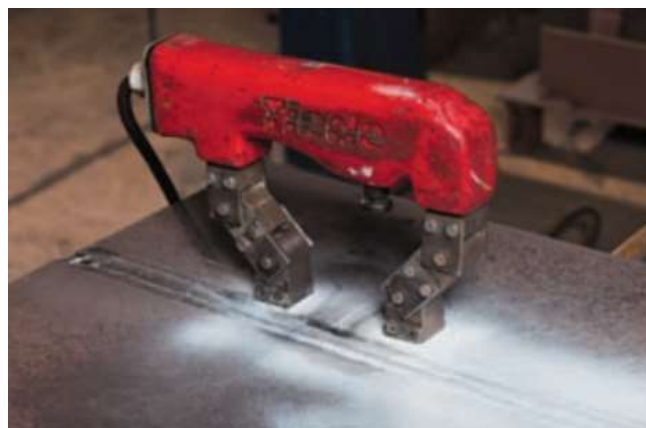
Slika 44 – Ispitivanje kvalitete zavara magnetskom metodom [16]
