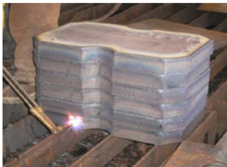
Slika 17 - Ručno zagrijavanje nakon rezanja [16]
