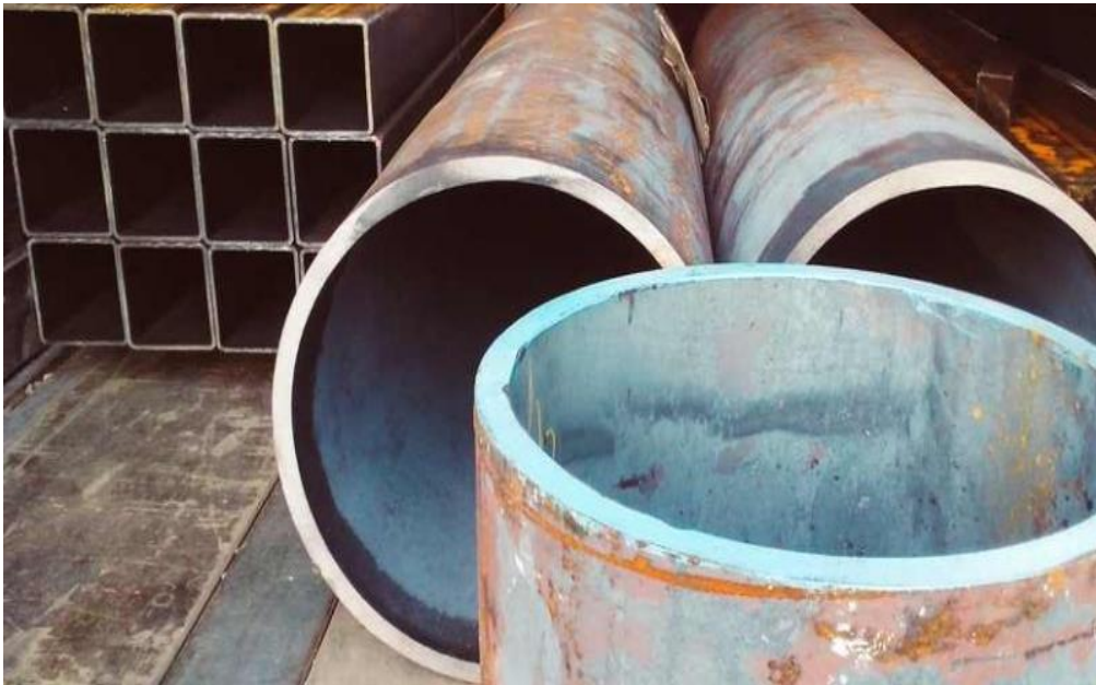
Slika 1: Toplo valjani šuplji profil [3]
