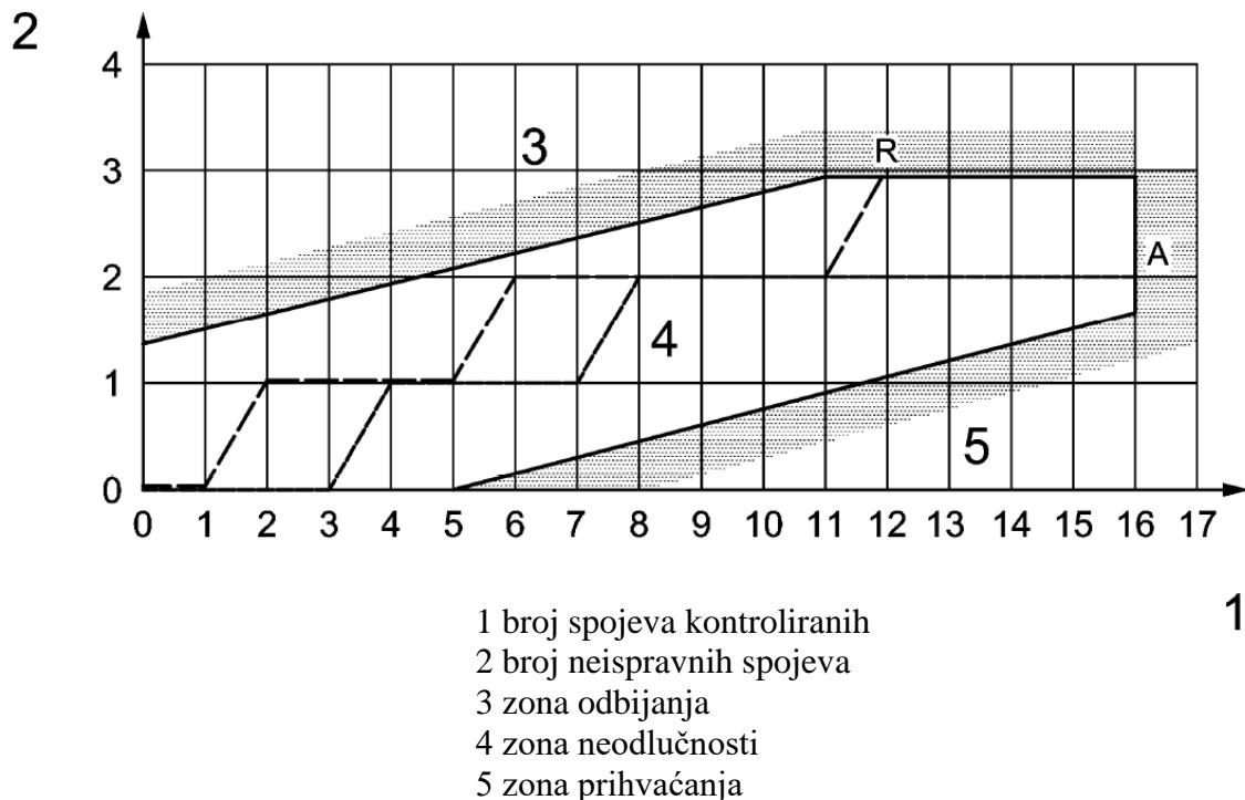
Slika 22. Primjer metode kontrole u skladu sa sekvencijalnim planom uzimanja uzorka za kontrolu [7]
