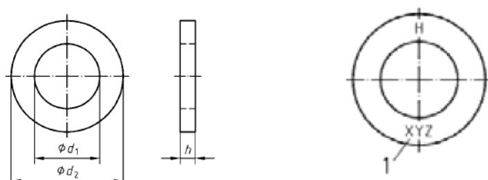
*Slika 15. Ravne podložne pločice [8]*
