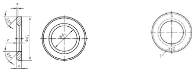
Slika 16. Ravne podložne pločice, skošene [8]
