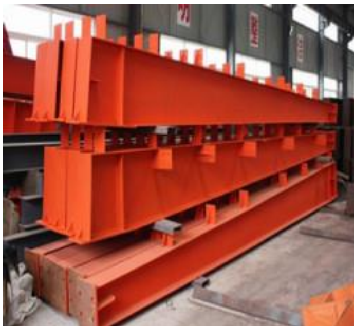
Slika 28.: Primjer obojanih čeličnih nosača [28]
