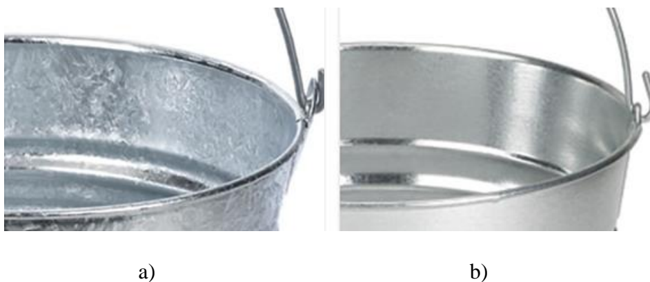
Slika 24.: Razlika između proizvoda koji su pocinčani uranjanjem a) i elektrogalvaniziranjem b) [23]
