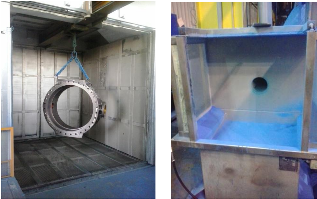
Slika 2.9 Predgrijavanje komada i komora za fluidizaciju [13]
