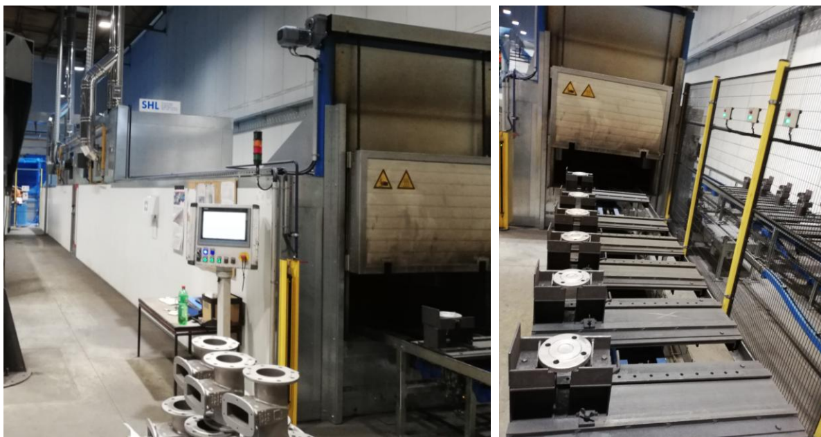
Slika 2.12 Peć za predgrijavanje odljevaka [13]
