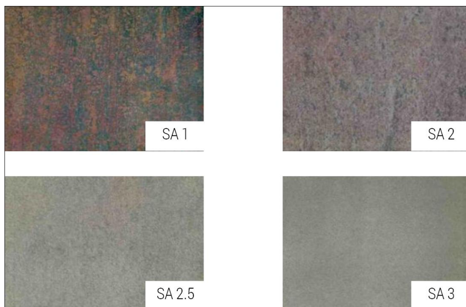
Slika 2.3 Izgled površine čistoće Sa 2½ [5]
