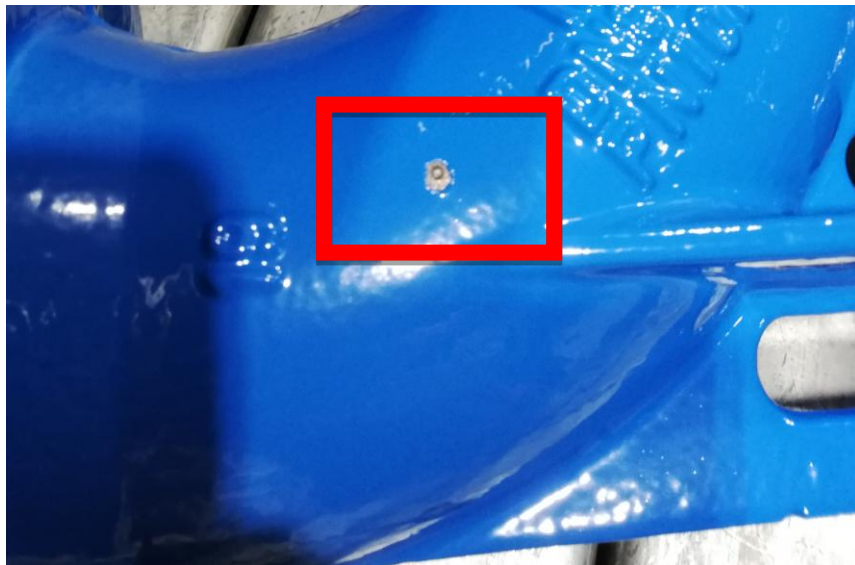
Slika 2.16 Oštećenje od prihvata [13]
