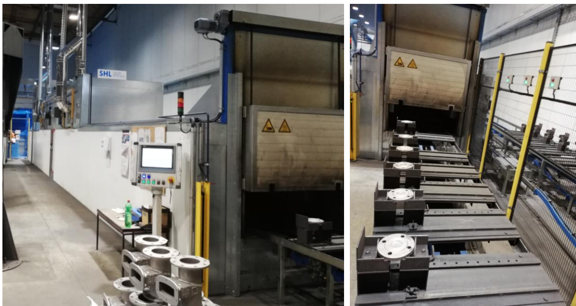
Slika 2.12 Peć za predgrijavanje odljevaka [13]
