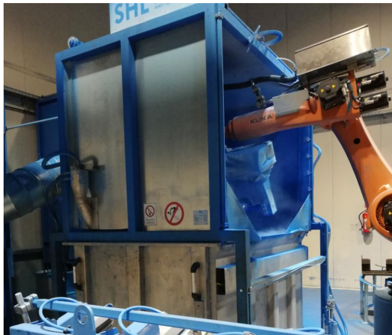
Slika 2.14 Bazen za fluidizaciju praha [13]
