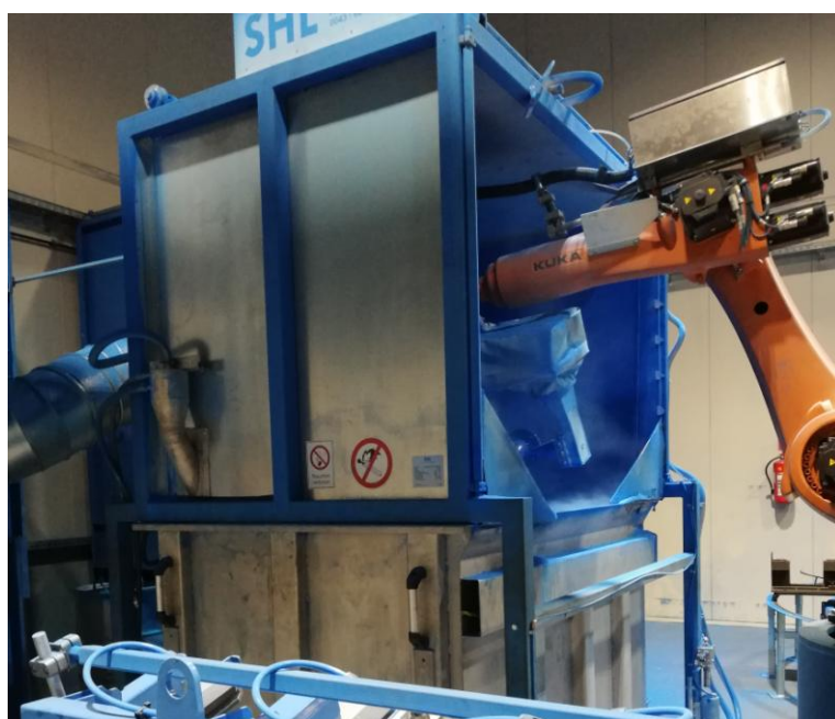
Slika 2.14 Bazena za fluidizaciju praha [13]
