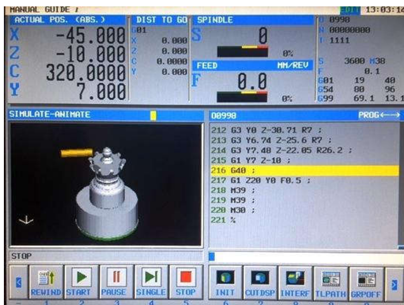
Slika 3.2.22 Grafička simulacija glodanja utora
