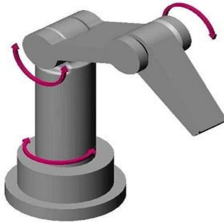
Slika 4. Rotacijska konfiguracija robota
