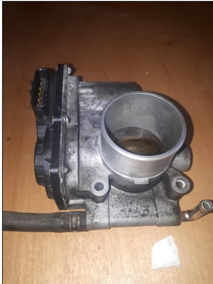
Slika 4.2.2.5. Leptir gasa nakon čišćenja
