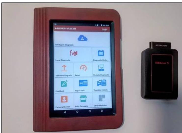
Slika 4.1.2. Tablet sa dijagnostičkim programom i VCI konektor
