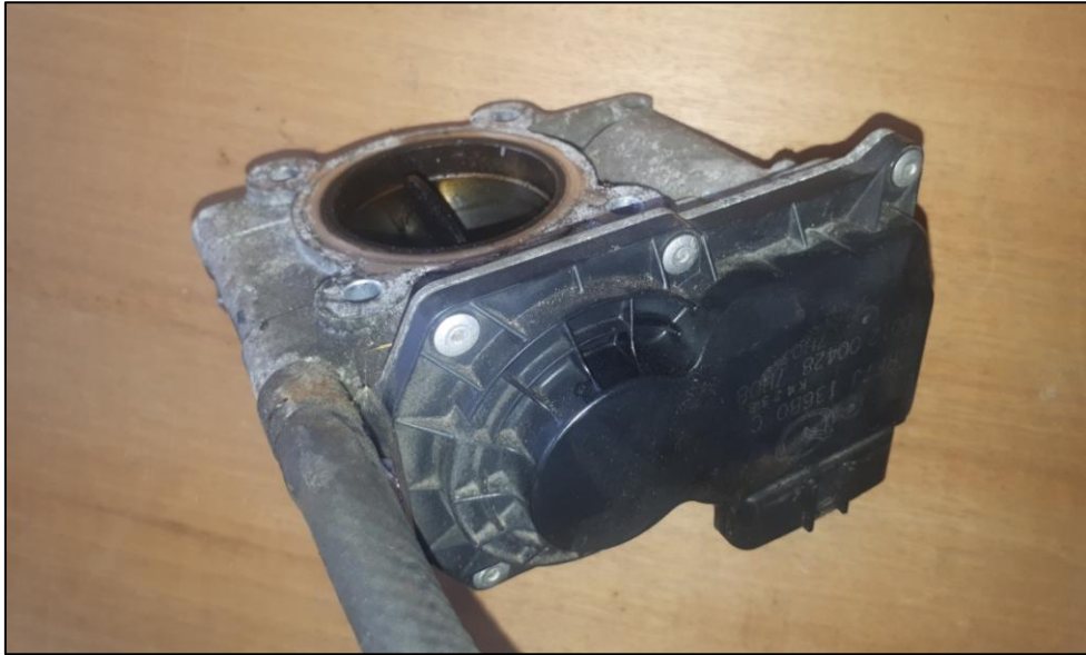
Slika 4.2.2.4. Leptir gasa prije čišćenja
