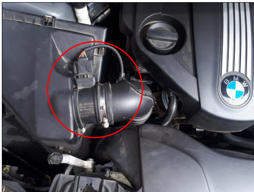
Slika 4.2.1.5. Položaj MAF senzora na vozilu
