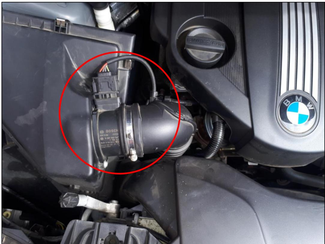
Slika 4.2.1.5. Položaj MAF senzora na vozilu
