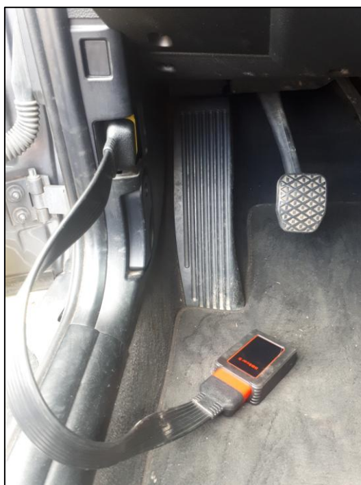
Slika 4.2.1.2. Spajanje VCI konektora na DCL
