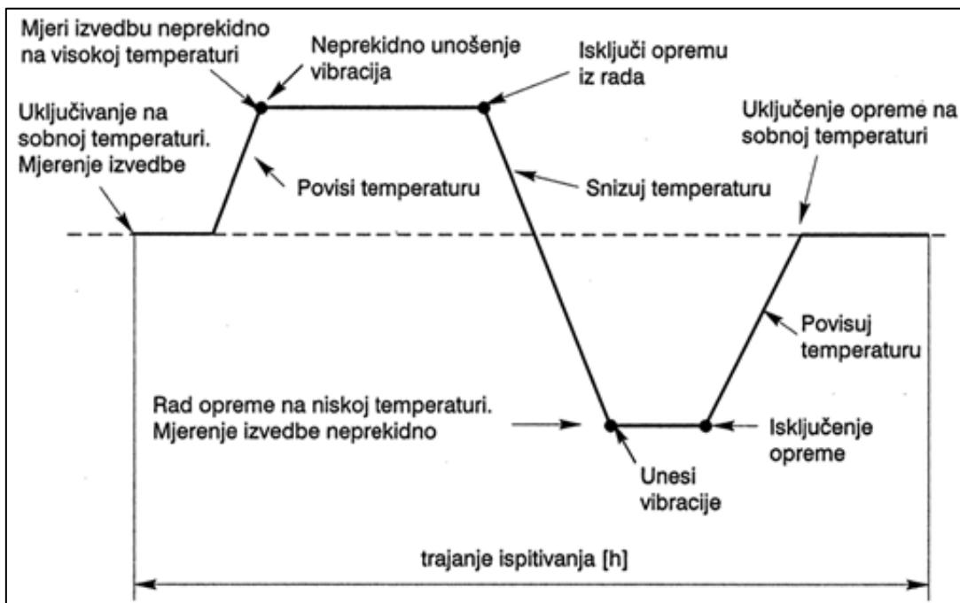
**Slika 2.2.** Primjer plana ispitivanja pouzdanosti sustava [3]
