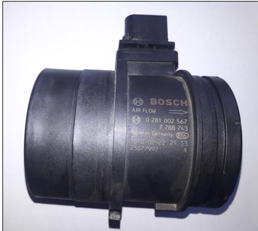
Slika 4.2.1.4. Senzor masenog protoka zraka (MAF senzor)
