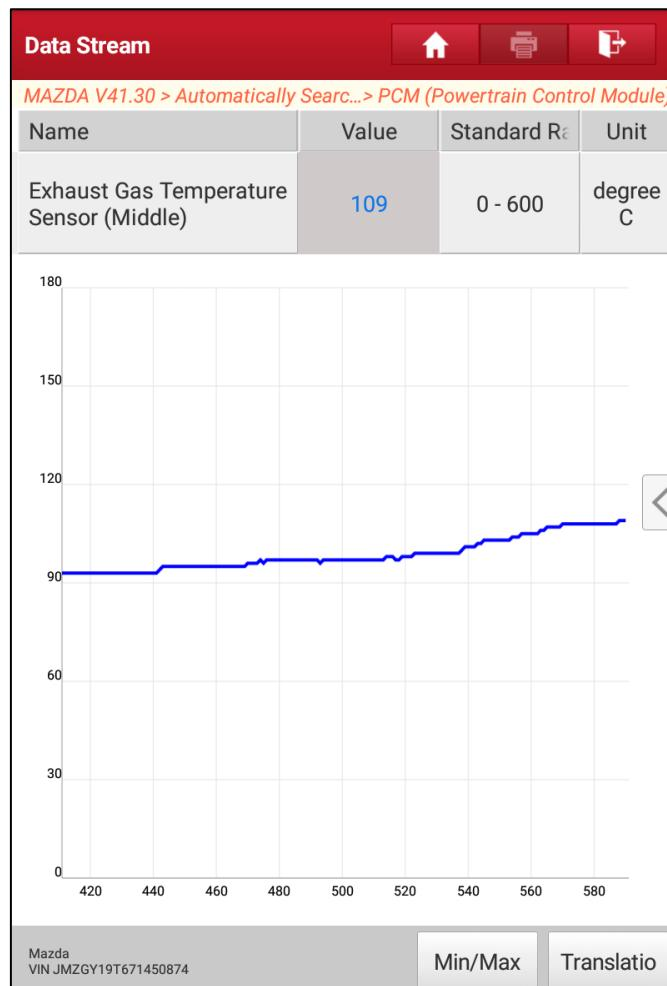
**Slika 4.2.2.3.** Provjera rada senzora temperature ispušnih plinova
