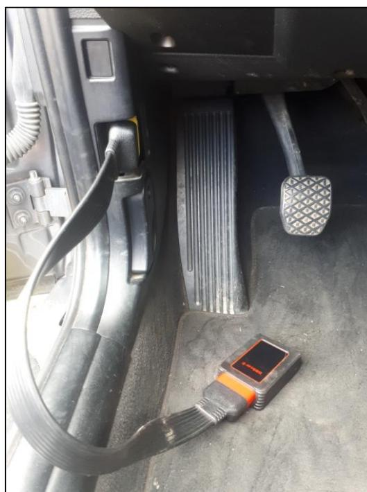
**Slika 4.2.1.2.** Spajanje VCI konektora na DCL
