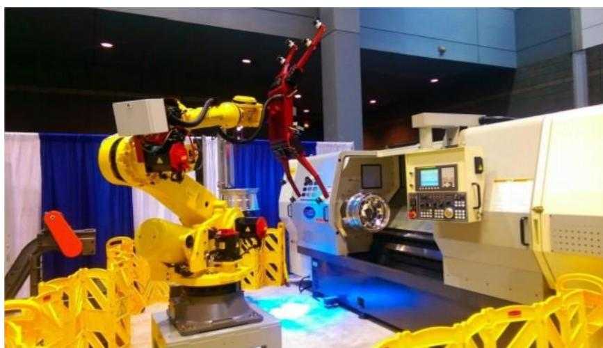
Slika 3.2.1.1. Izmjena obradka uz pomoć robota[10]
