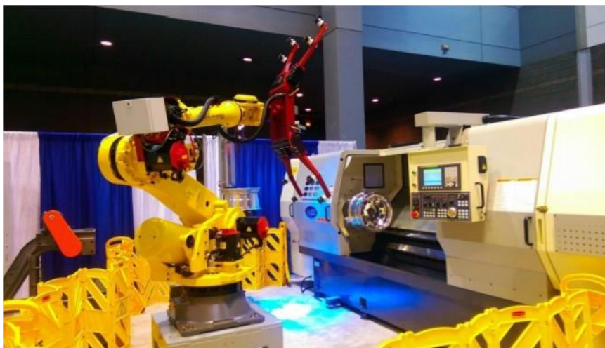
Slika 3.2.1.1. Izmjena obradka uz pomoć robota[10]
