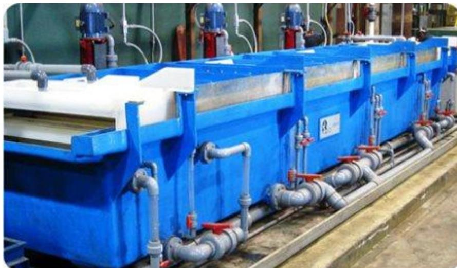
Slika 2.1.3. Višestupnjeviti sistem za dekapiranje[4]
