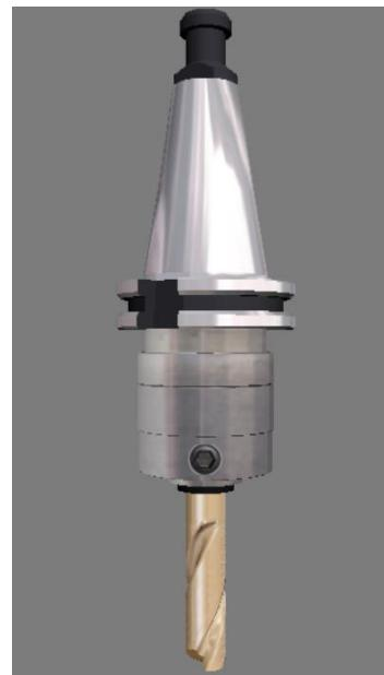
Slika 3.3 Alat za glodanje utora 20 mm
