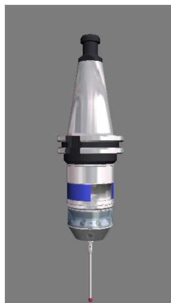
Slika 3.7 Sonda za mjerenje
