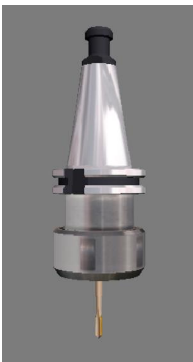
Slika 3.6 Alata za bušenje navoja M10
