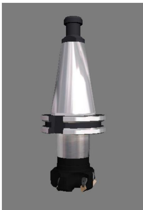
Slika 3.2 Alat za čeono glodanje 63 mm
