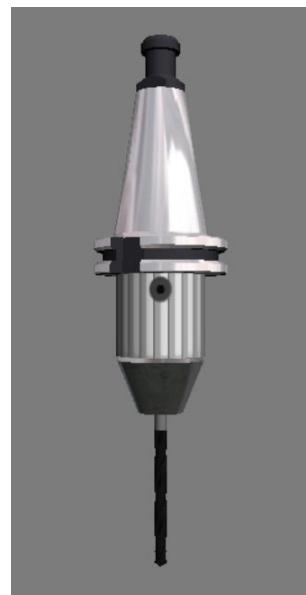
Slika 3.5 Spiralni alat za bušenje 8,5 mm
