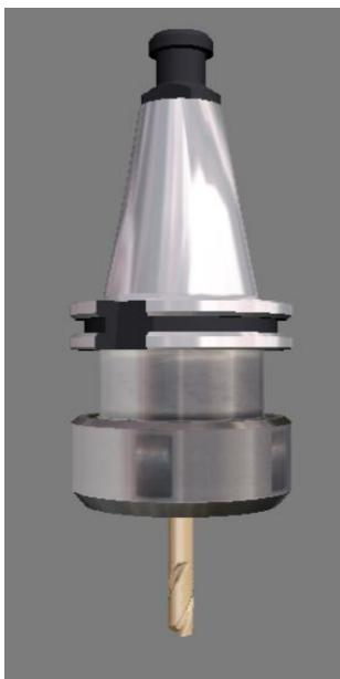
Slika 3.4 Alat za glodanje utora 10 mm
