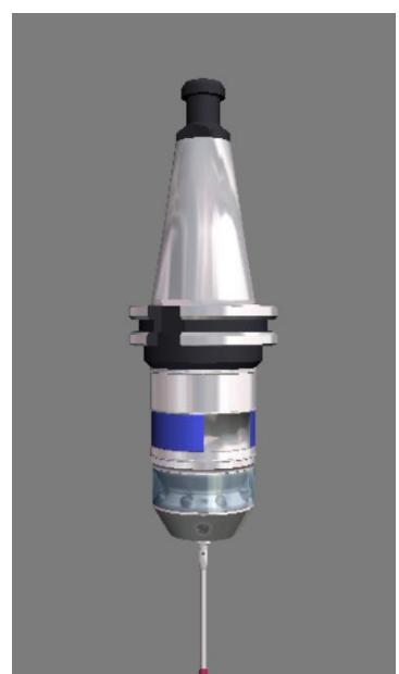
Slika 3.7 Sonda za mjerjenje
