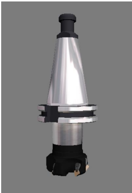
Slika 3.2 Alat za čeono glodanje 63 mm
