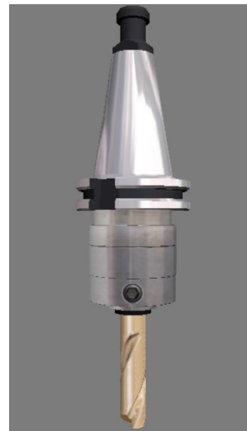
Slika 3.3 Alat za glodanje utora 20 mm
