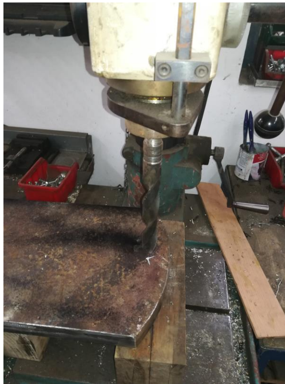
Slika 5.4.. Bušenje postolja na stupnoj bušilici
