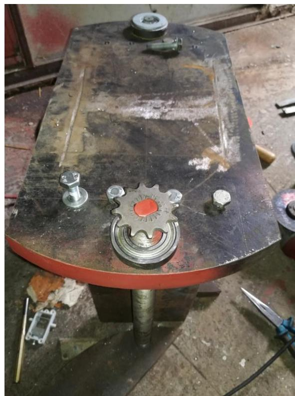
*Slika 5.11. Montaža pogonskih lančanika na navojna vretena*
