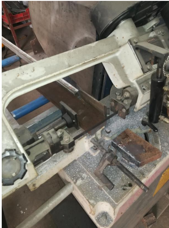
Slika 5.6.. Rezanje čeličnih limova
