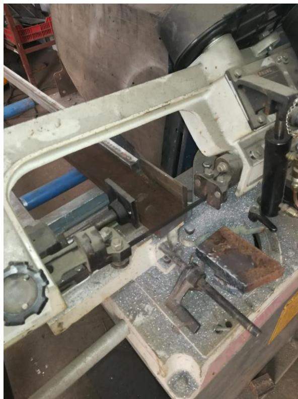
Slika 5.6.. Rezanje čeličnih limova
