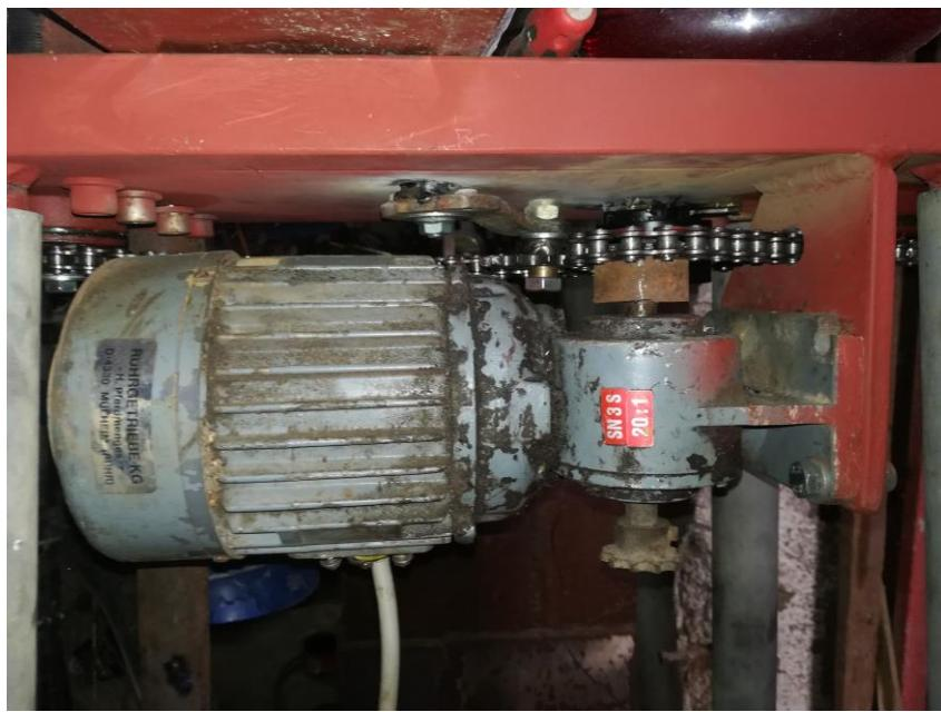
Slika 5.14. Pogonski agregat
