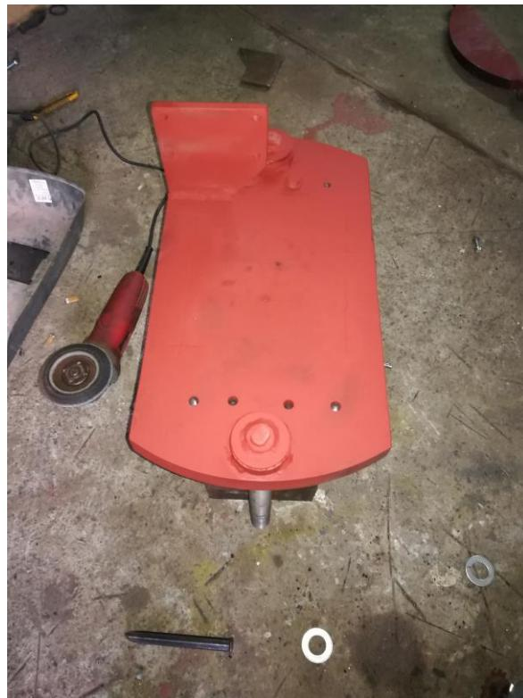
*Slika 5.9.. Montaža ležajeva i nosača ležaja*
