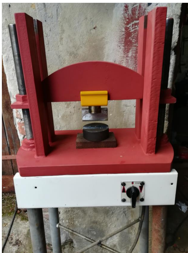
Slika 5.17.. Gotov model elektromehaničke vretenaste preše
