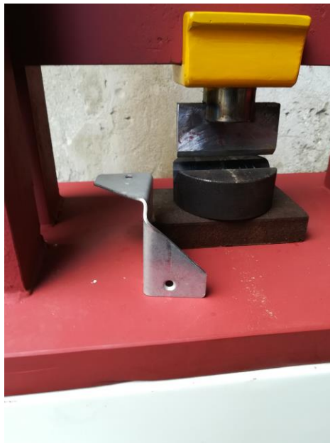
Slika 7.2.. Savijen lim debljine 3 mm
