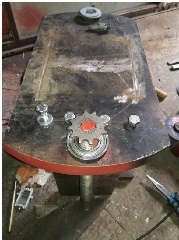
Slika 5.11. Montaža pogonskih lančanika na navojna vretena
