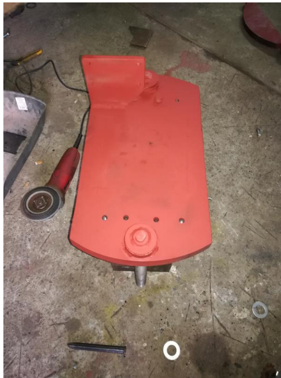
Slika 5.9.. Montaža ležajeva i nosača ležaja
