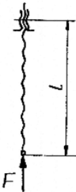
Slika 3.2.. Shema za izvijanje vretena [11]
