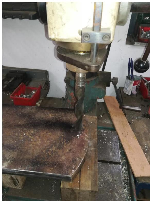
*Slika 5.4.. Bušenje postolja na stupnoj bušilici*
