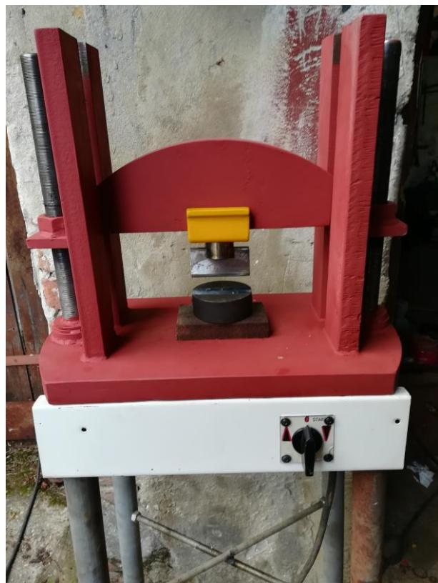
*Slika 5.17.. Gotov model elektromehaničke vretenaste preše*
