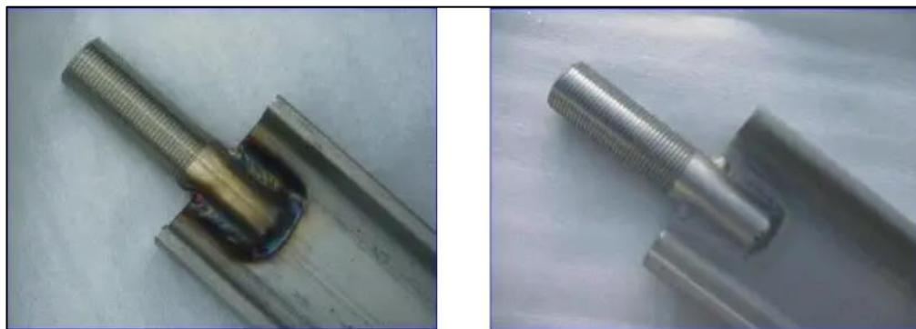
Slika 46: Izgled zavara prije (lijevo) i poslije (desno) nagrizzanja [46]
