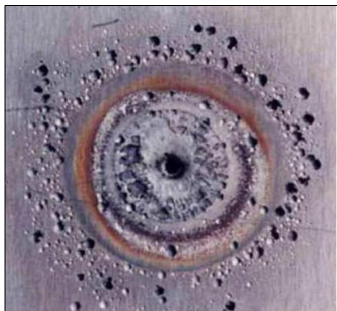
Slika 13: Točkasta korozija [20]
