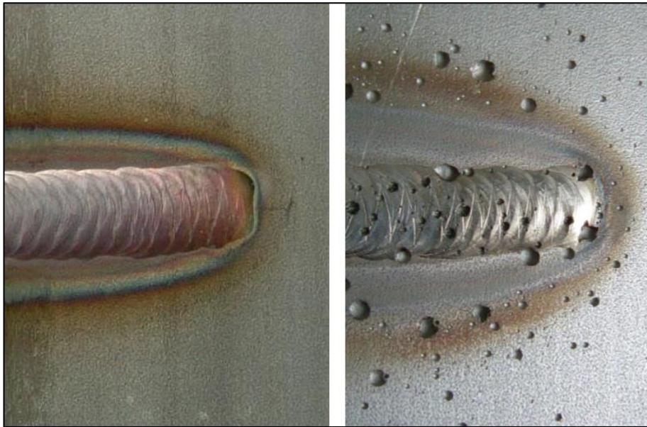
Slika 44: Nastanak točkaste korozije zbog obojenosti [13]
