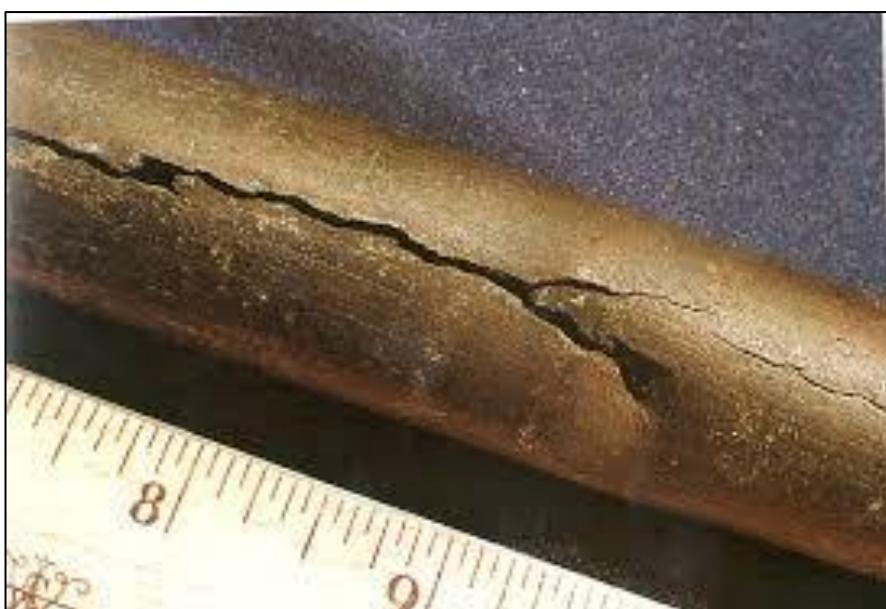
Slika 18: Napetosna korozija [7]
