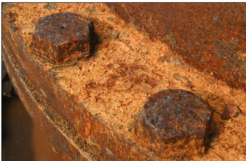
Slika 12: Opća korozija [17]
