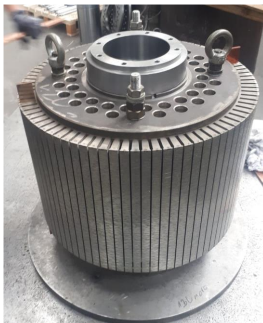
Slika 3.7 Paket spreman za naprešavanje
