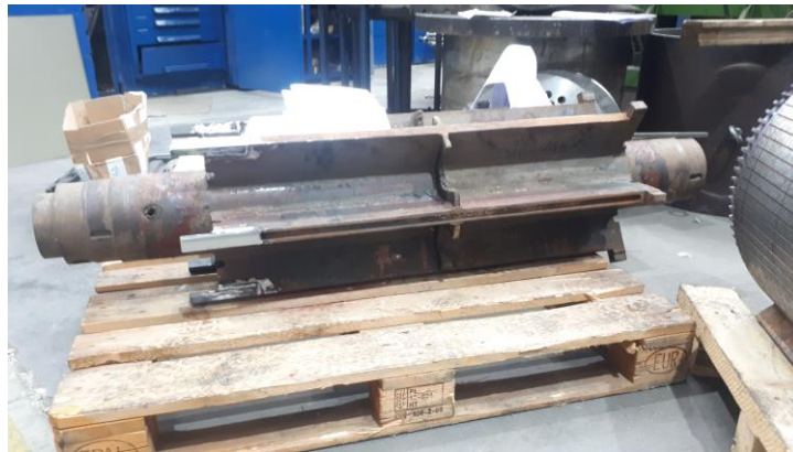
Slika 3.10 Pomoćna osovina s rebrima
