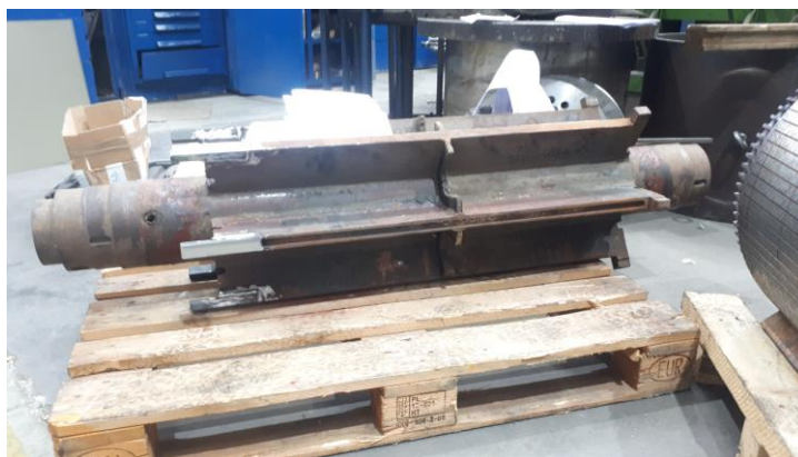
Slika 3.10 Pomoćna osovina s rebrima
