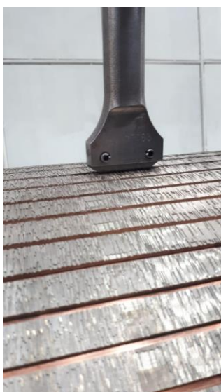
Slika 3.14 Alat za raskivanje štapova
