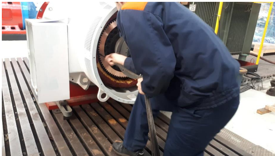
Slika 4.2 Ispitivanje zračnog raspora limovima
