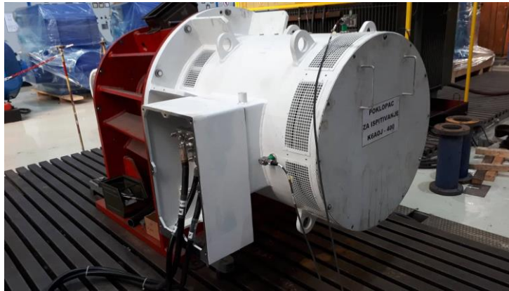
Slika 4.3 Zatvaranje kućišta i spajanje motora na mrežu
