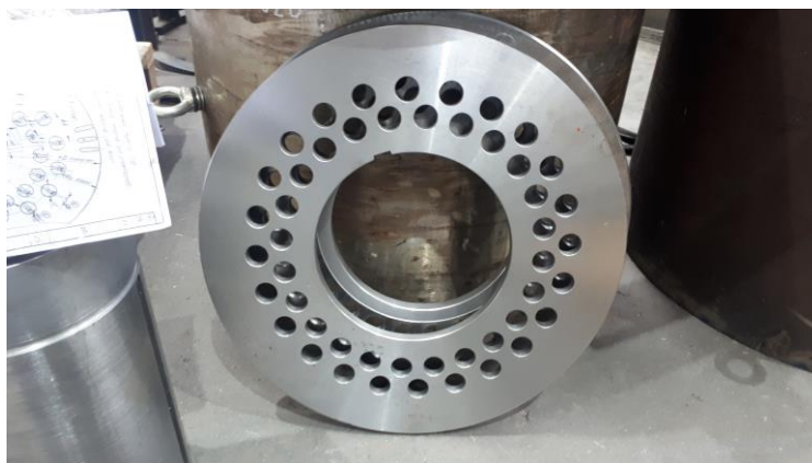
Slika 2.13 Tlačna ploča sa provrtima za hlađenje paketa
