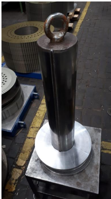
Slika 3.1 Naprava za pakiranje sa postavljenom tlačnom pločom
