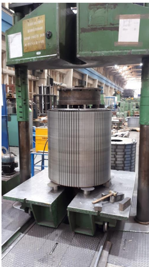
Slika 3.3 Paket spreman za prešanje
