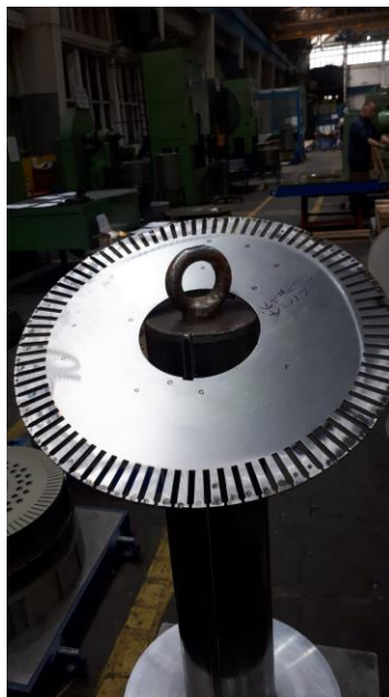
Slika 3.2 Ulaganje krajnjeg lima na napravo za pakiranje
