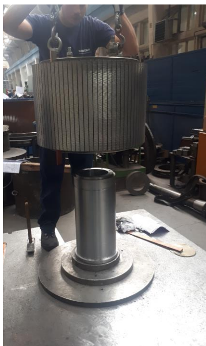
Slika 3.6 Postavljanje paketa na glavinu osovine
