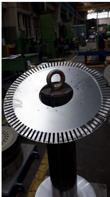
Slika 3.2 Ulaganje krajnjeg lima na napravo za pakiranje
