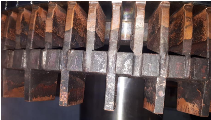
Slika 3.16 Zalemljeni štapovi na kratkospojnom prstenu
