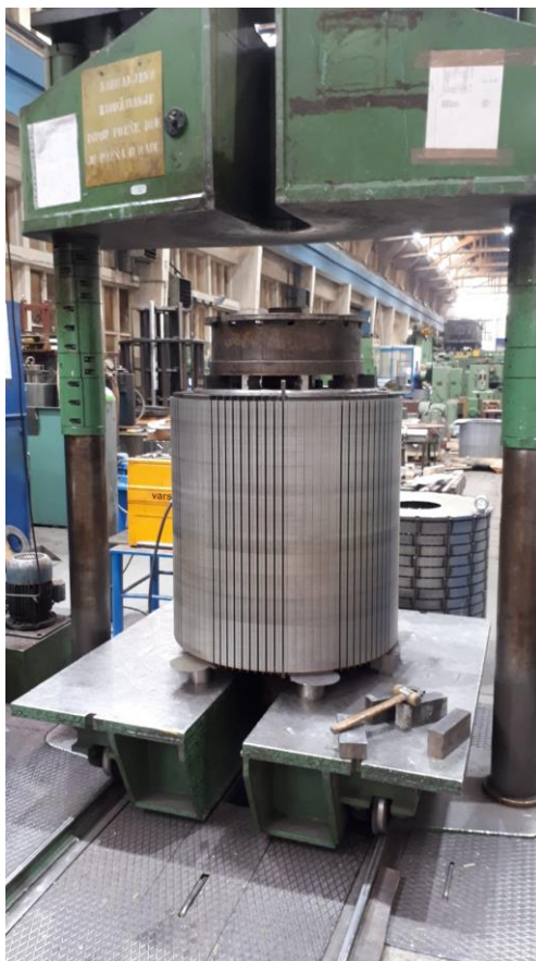
Slika 3.3 Paket spreman za prešanje
