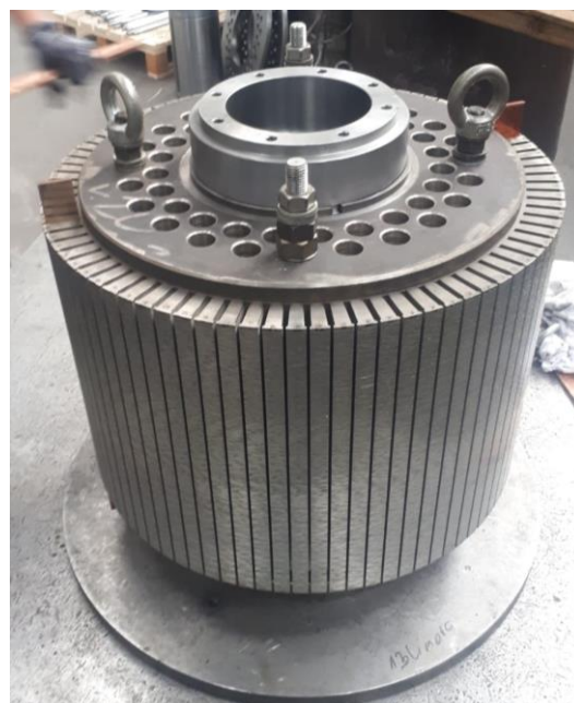
Slika 3.7 Paket spreman za naprešavanje
