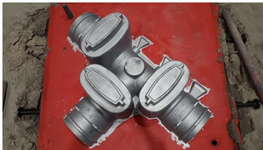
Slika 6.4: Donjak premazan premazom za zaštitu od abrazije
