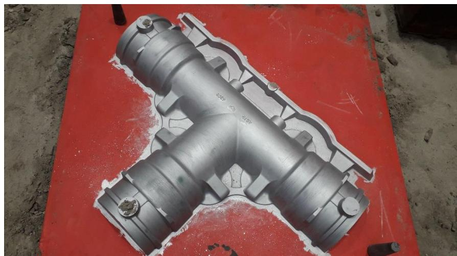
Slika 6.1: Gornjak premazan premazom za zaštitu od abrazije
