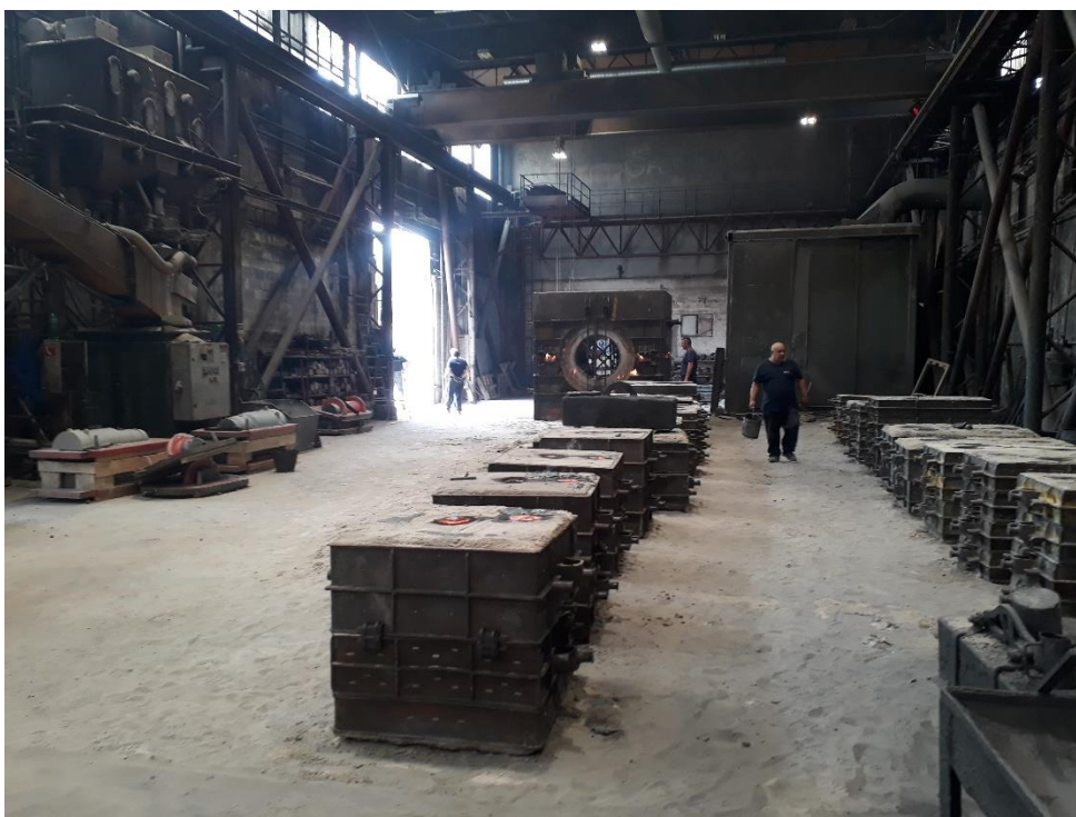
Slika 6.9: Odlijani kalupi u hali za ručno kalupljenje
