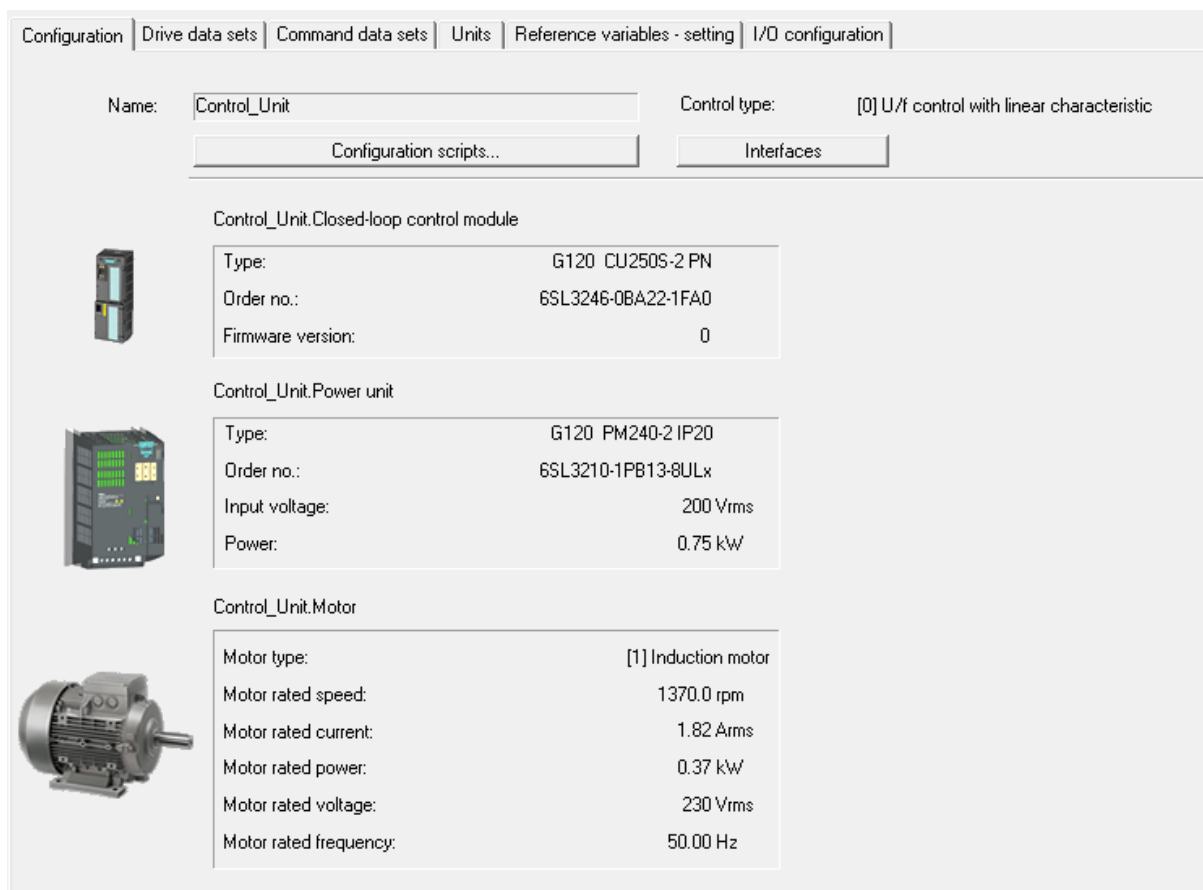
Slika 5.4 Konfiguracija frekventnog pretvarača u STARTER-u
