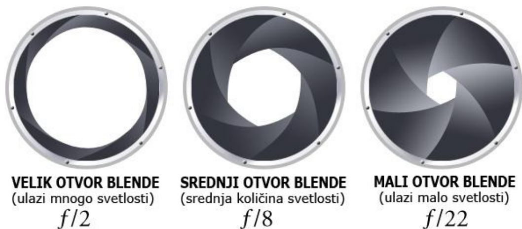
Slika 10: Prikaz manipulacije otvora blende
