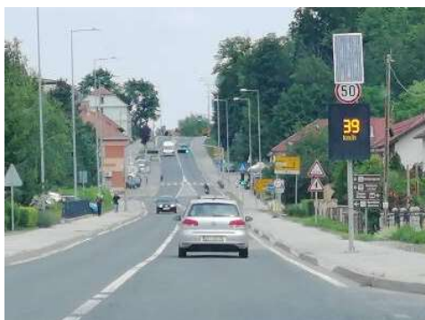
Slika 32. Svjetlosni znak za upravljanje prometom uz statični znak ograničenja brzine.
