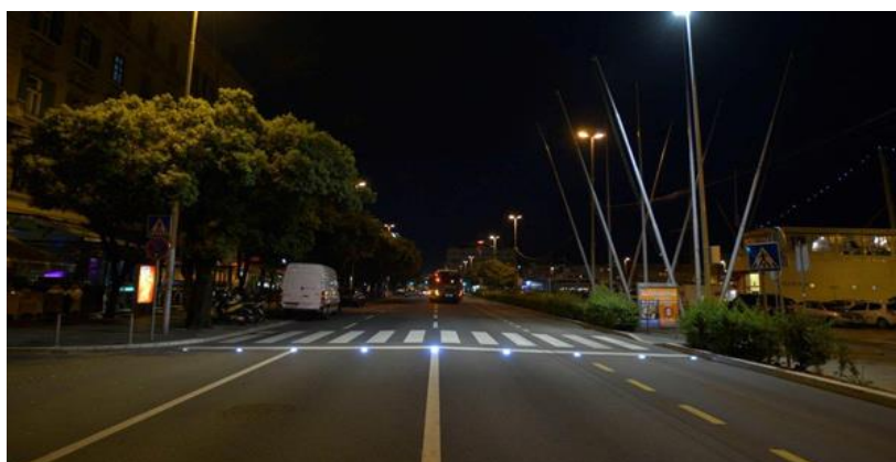
Slika 7. Obilježavanje pješačkog prijelaza LED prometnim svjetlima
