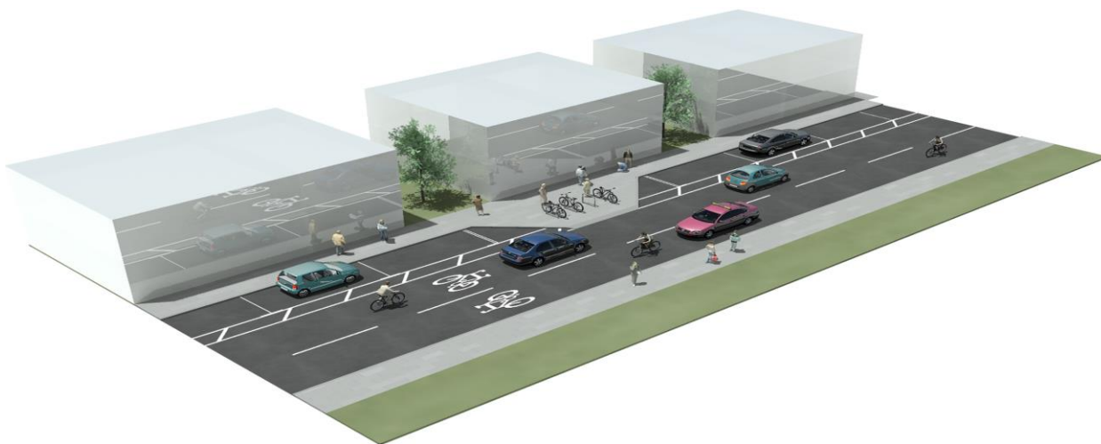
Fotografija 15: Shema uzdužnog parkiranja
