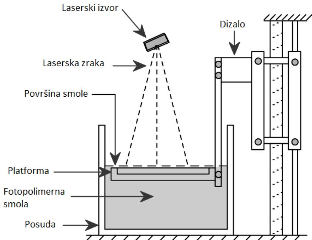
Slika 12. Stereolitografski postupak
