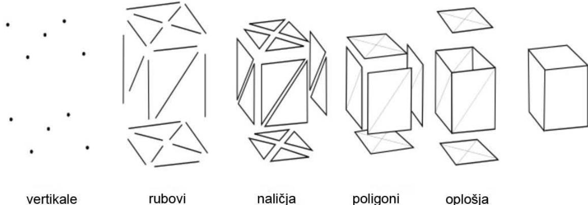
Slika 29. Elementi modeliranja u Meshlabu
