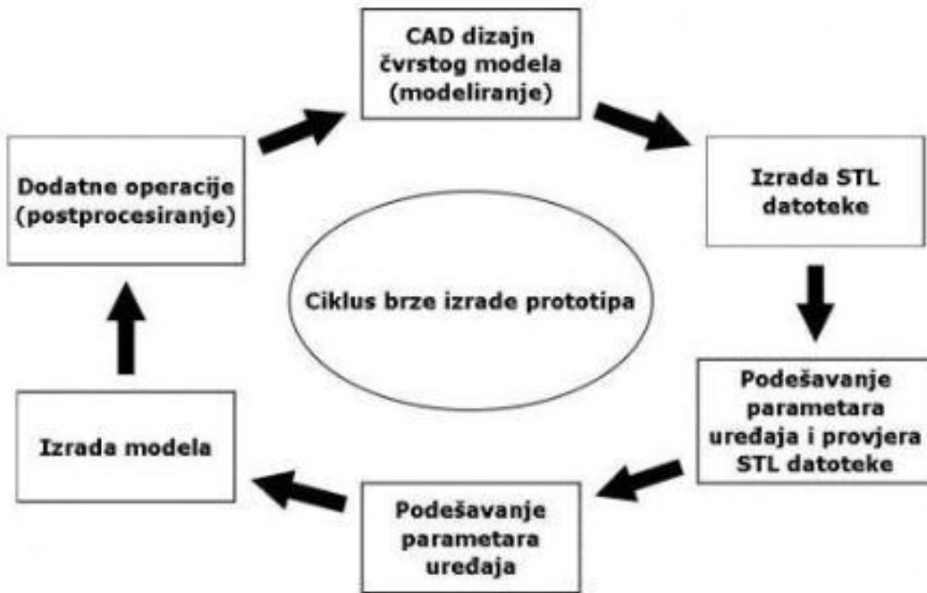
Slika 10. Shematski prikaz izrade prototipa za 3D tiskanje
