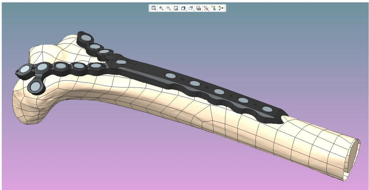
Slika 18. Digitalni prikaz modela kosti sa modeliranim odgovarajućom pločicom
