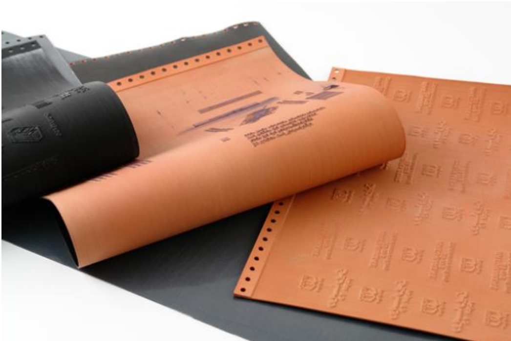
Slika 7. Gumene tiskovne forme za fleksotisak [11 ]
