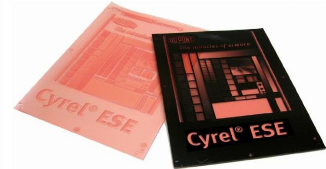
Slika 8. Tiskovne forme od čvrstog fotopolimera [12]
