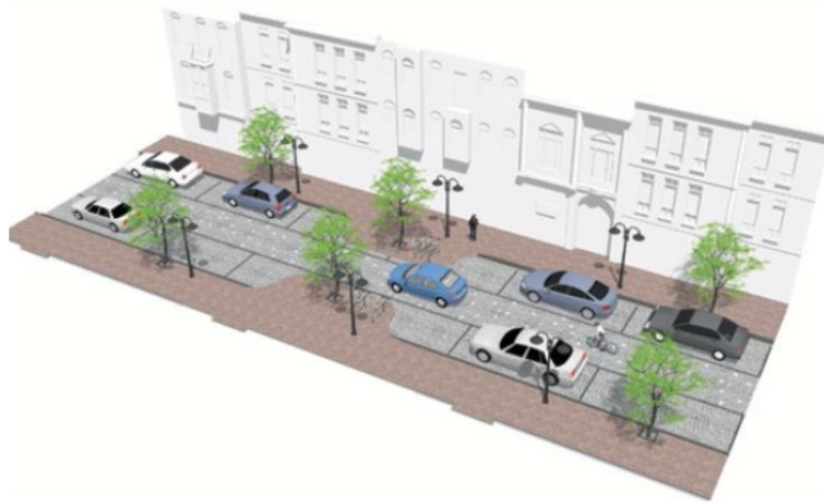
Slika 7.1.4. Skica „otoka“ tj. proširenih pločnika kojima se smanjuje širina ulice radi smanjenja brzine kretanja motornih vozila [3]
