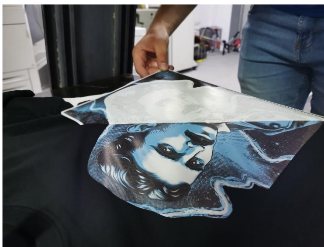
Slika 26: Prikaz tiska rasterske grafike na tamnu podlogu
