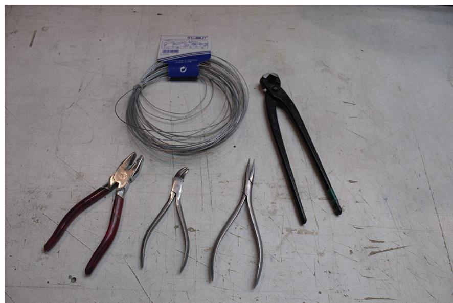
Slika 7.10. Alat za savijanje i obradu žice
