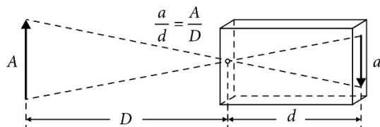
Slika 2.1 Princip rada camere obscure
