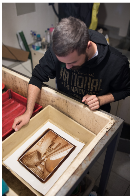
Slika 5.14 Fiksiranje osvijetljenog papira
