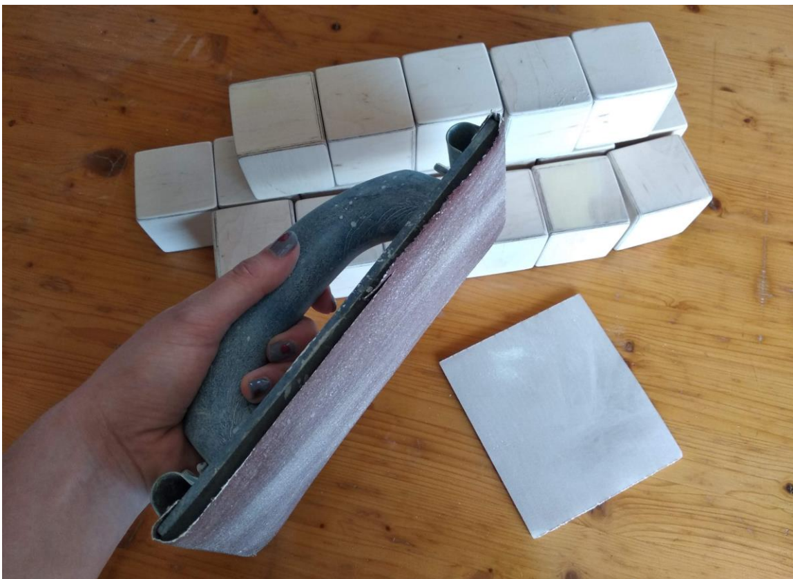
Slika 5.3 17 Pribor korišten za obradu bridova i vrhova
