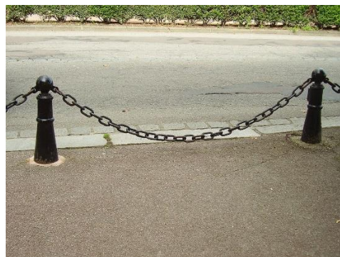
Slika 5.7. Lančanica-teorijski oblik lanca koji je obješen za svoja dva kraja na istoj visini, koji je u ravnoteži i na kojeg djeluje uniformna gravitacijska sila (težina).; Izvor: httpsen.wikipedia.org/wiki/Catenary#mediaFile-Kette_Kettenkurve_Catenary_2008_PD.JPG
