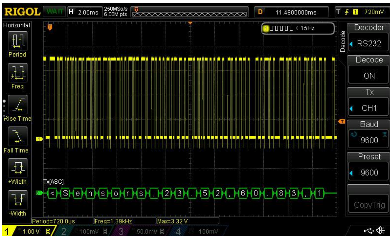
Slika 3.11: Testiranje sklopa za promjenu razine napona 5V na 3.3V - osciloskop
