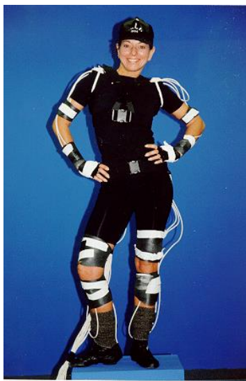
Slika 3.6 Primjer mocap odijela sa magnetskim senzorima
