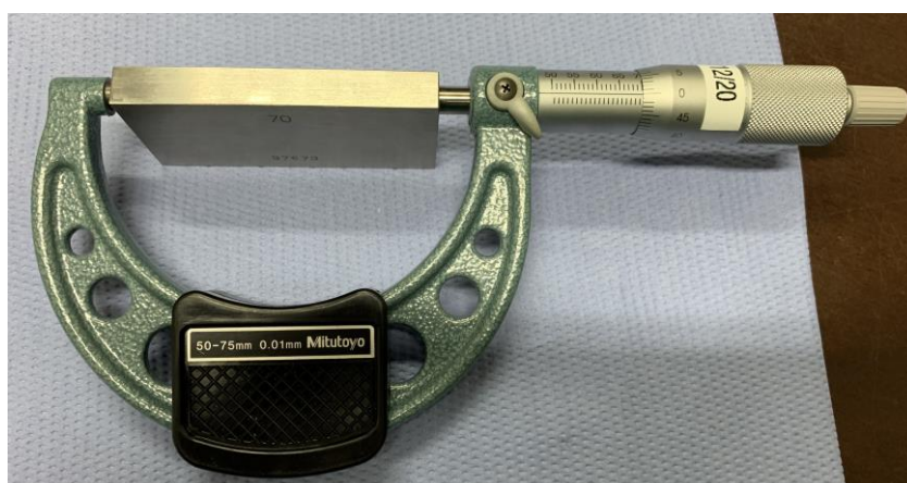
Slika 6.26. Mikrometar – provjera sa etalonom duljine 70 [mm] [10]
