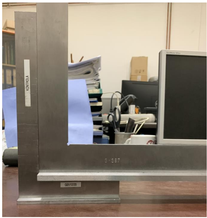
Slika 6.28. Kutnik - kontrola unutarnjeg kuta pomoću kontrolnog kutnika [10]
