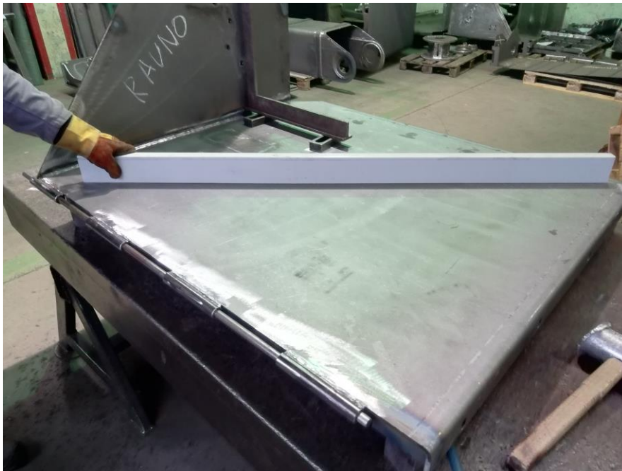
Slika 6.15. Kontrola ravnosti metalnim ravnalom (libelom) [10]
