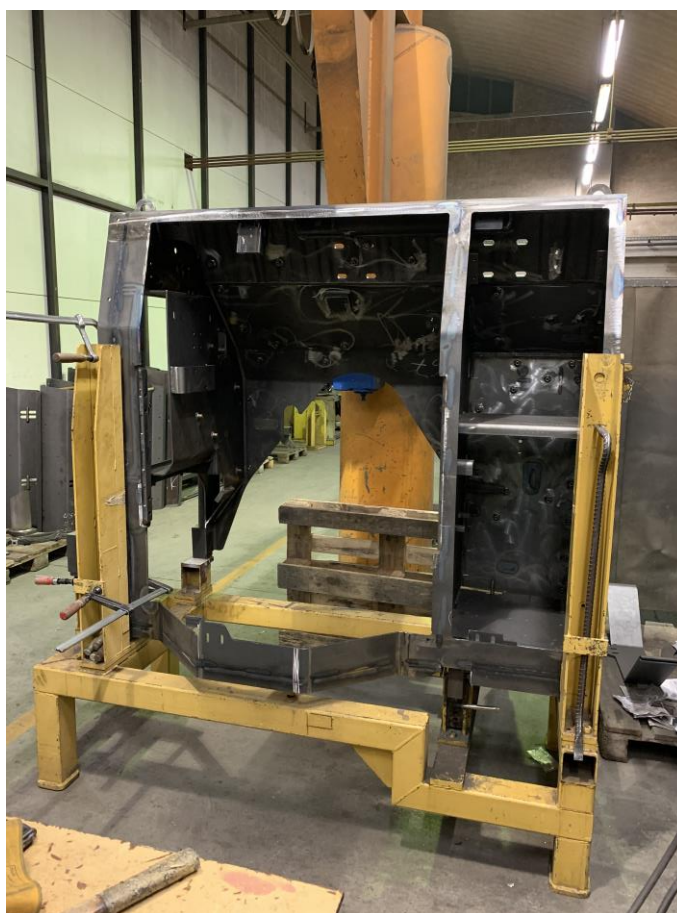
Slika 6.4. Proizvod „PUMPENKASTEN“ u napravi [10]
