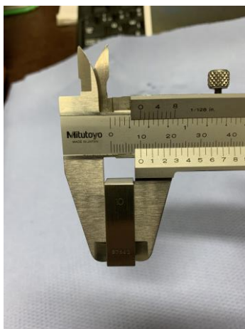
Slika 6.19. Pomično mjerilo – provjera sa etalom duljine 10 [mm] [10]
