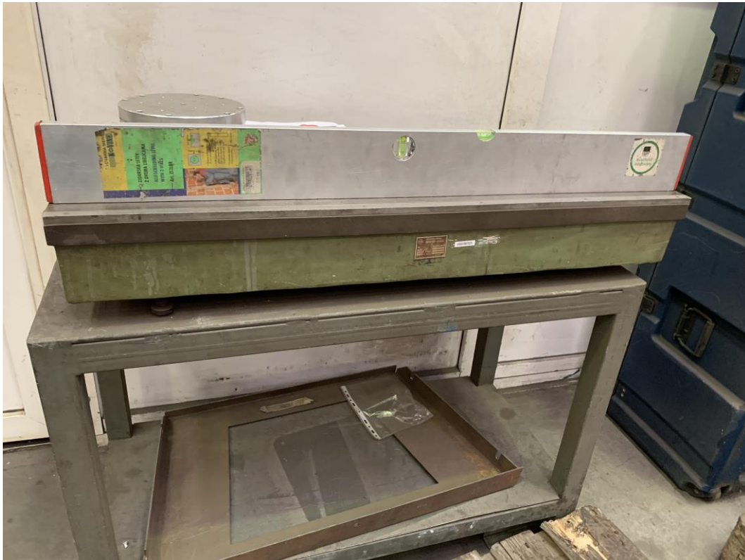
Slika 6.31. Kontrola ravnosti libele na mjernom stolu [10]
