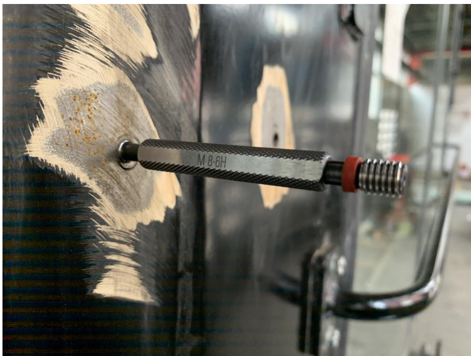
Slika 6.11. Kontrola kalibričnosti navoja pomoću kalibra (kontrolnog trna) [10]
