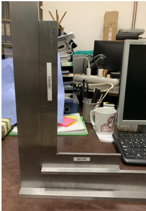
Slika 6.27. Kutnik - kontrola vanjskog kuta pomoću kontrolnog kutnika [10]
