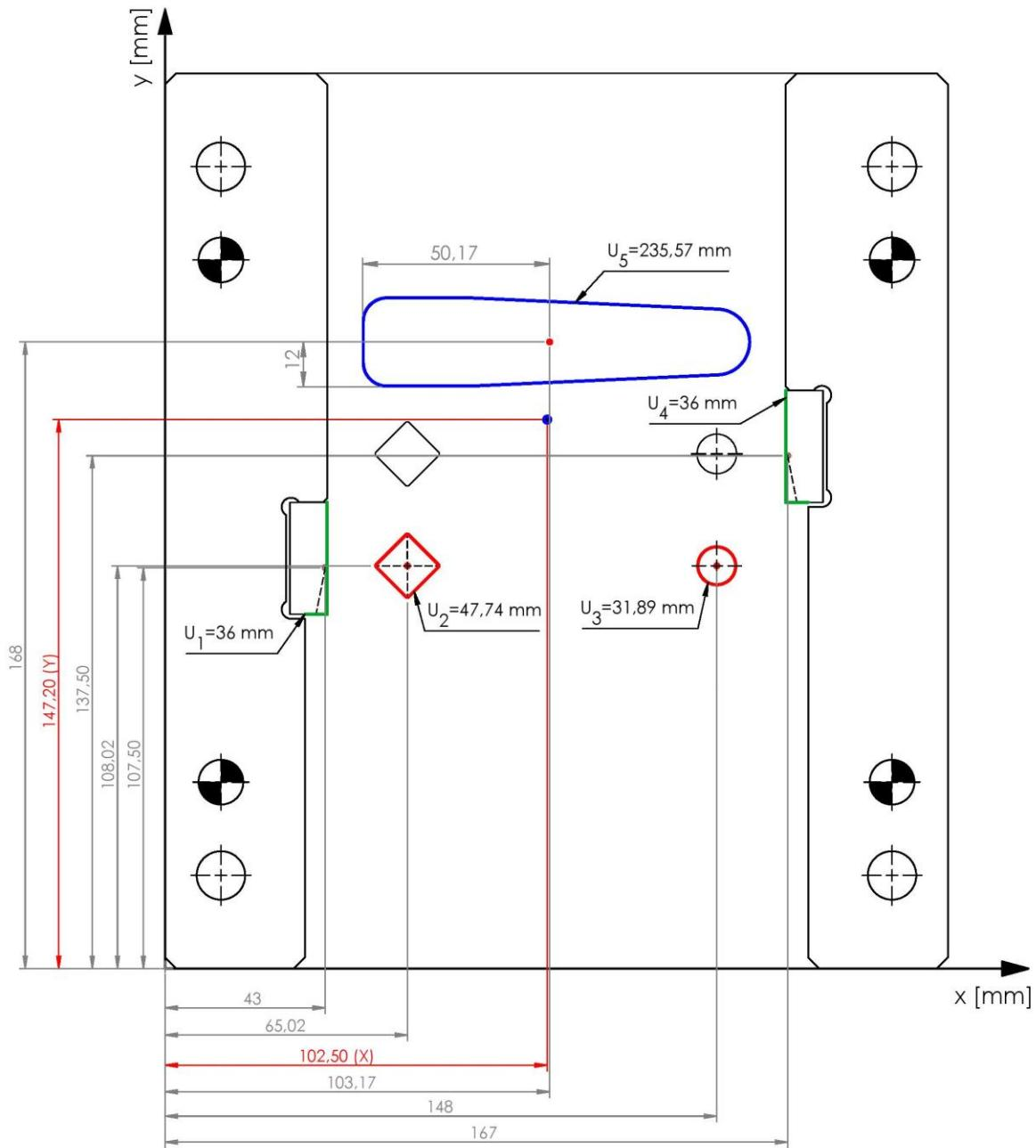
Slika 9.9 Dimenzije za izračun težišta alata
