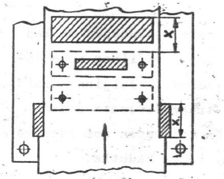
Slika 5.9 Određivanje koraka sa dva bočna noža [1]
