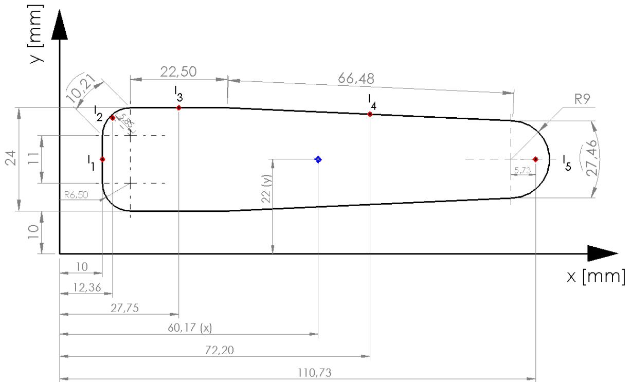
Slika 9.7 Dimenzije za izračun težišta oblika za izrezivanje
