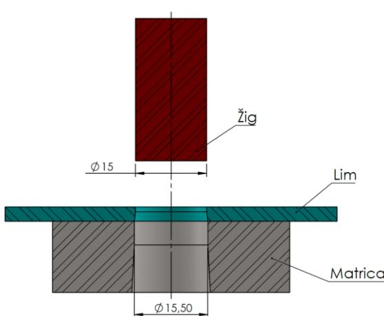
Slika 2.3 Primjer probijanja provrta Ø15
