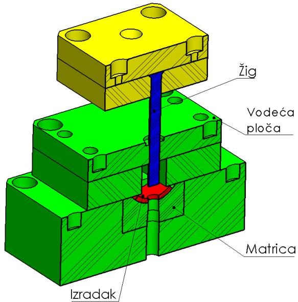
Slika 5.4 Primjer jednerezne štance za probijanje provrta
