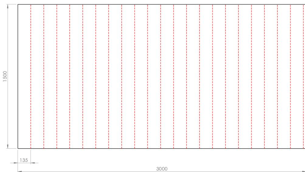
Slika 9.6 Krojenje ploče lima dimenzija  $3000 \times 1500 \text{ mm}$
