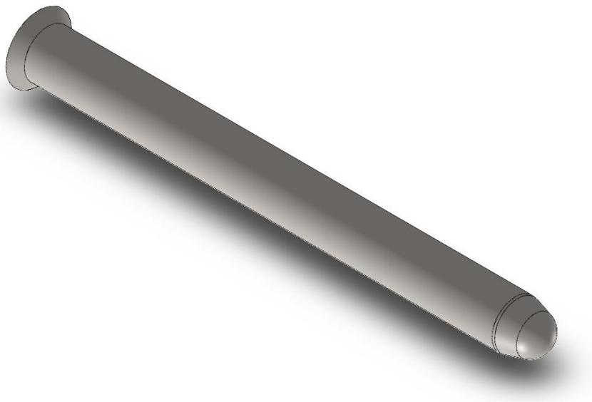
*Slika 10.23 3D model podešavala Ø10,10*
