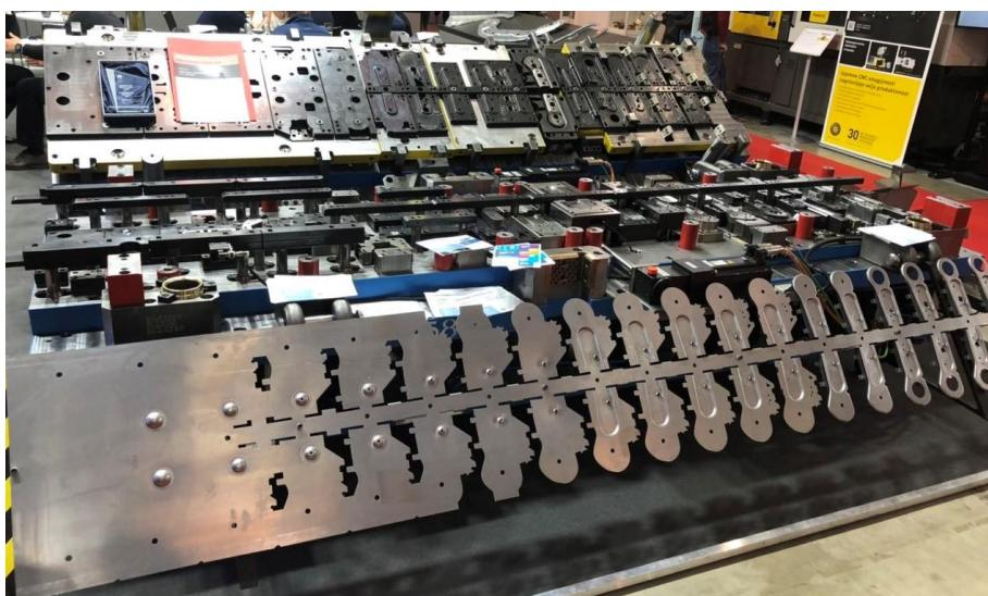
Slika 1.1 Prikaz štancane trake i slijednog alata
