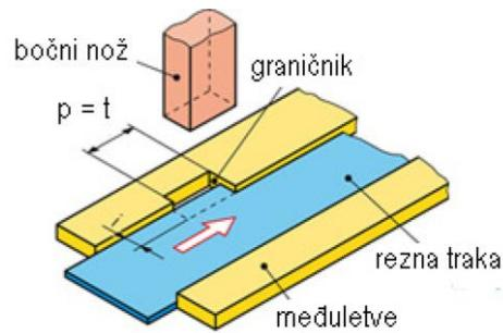
Slika 5.8 Određivanje koraka jednim bočnim nožem [4]
