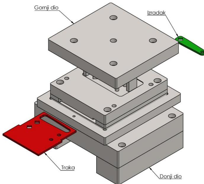
Slika 7.1 Sklop alata
