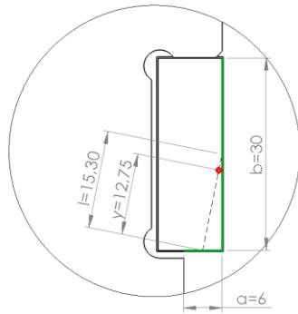
Slika 9.8 Detalj s dimenzijama – bočni nož
