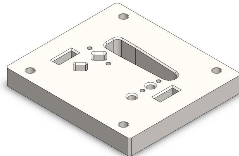
*Slika 10.27 3D model usadne ploče*
