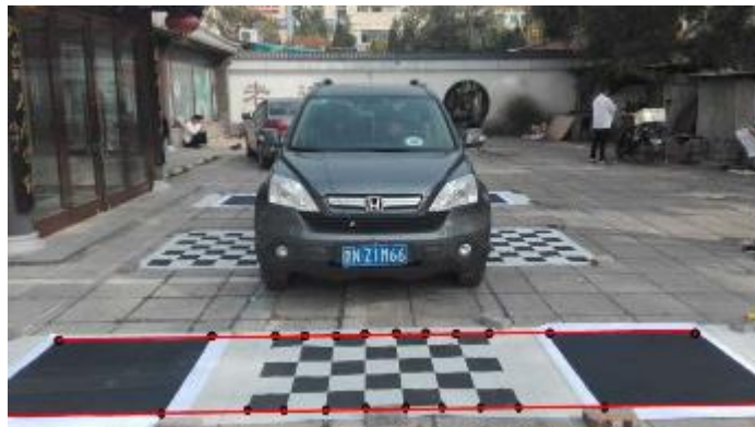
Slika 3.8 Specijalna kalibracijska ploča (označena crvenim linijama).
