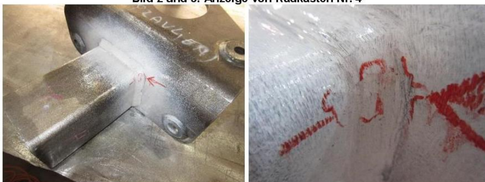
Bild 2 und 3: Anzeige von Radkasten Nr. 31
