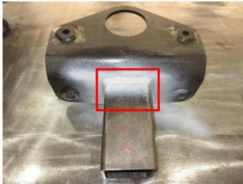
Bild 1: Übersicht Bauteil und Prüfbereich (SN umlaufend)
