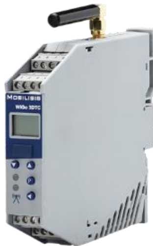
Slika 7.3.3: 3DTC brojač prometa
