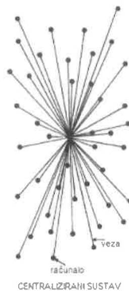
Slika 1 Dijagrami raspodijeljenog i centraliziranog sustava
