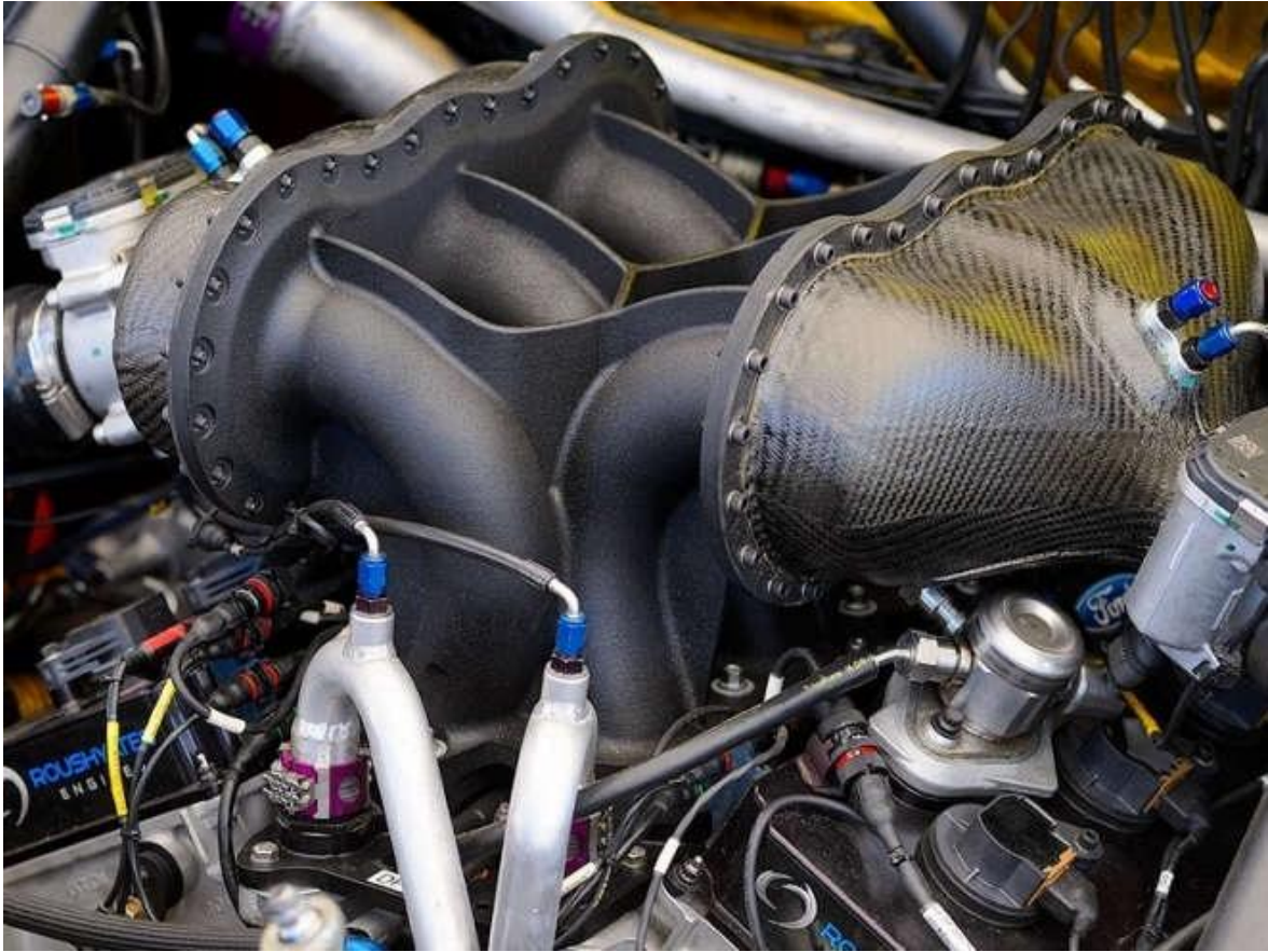
Slika 6: Fordova 3D isprintana usisna grana
