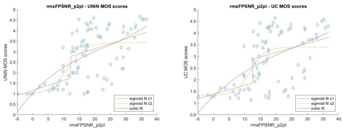
Slika 8.16: RMSE PSNR p2plane rezultati (UNIN-ljevo, UC-desno)
