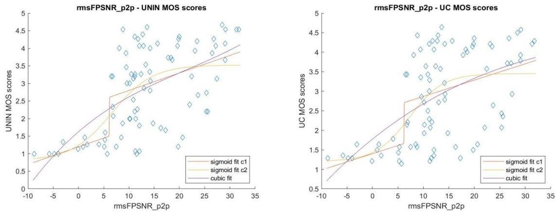
Slika 8.15: RMSE PSNR p2point rezultati (UNIN-ljevo, UC-desno)
