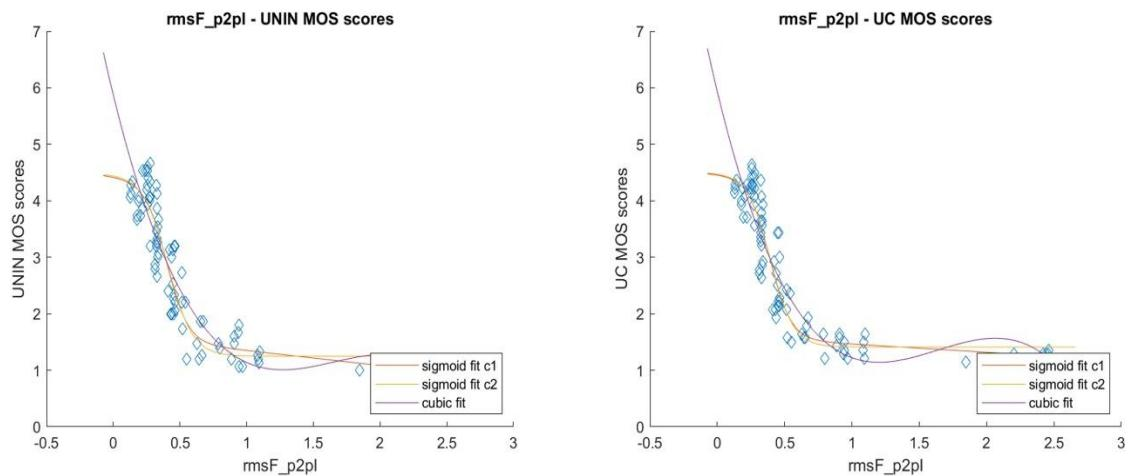
Slika 8.14: RMSE p2plane rezultati (UNIN-lijevo, UC-desno)
