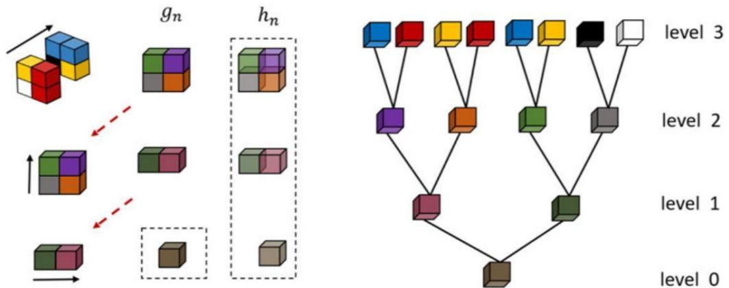
Slika 4.5: Transformacija bloka veličine  $2 \times 2 \times 2$  za octree kodiranje, izvor: [9]
