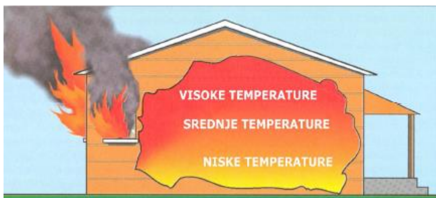
Slika 3.1 Odnos temperature pri požaru zatvorenog prostora
