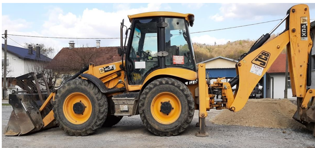
Slika 3.1. Prikaz stroja (kombinirka ICB 4CX) za izvođenje zemljanih radova
