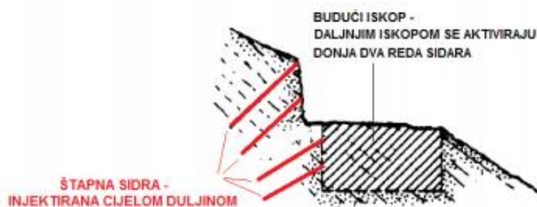
Slika 5.4. Zaštita štapnim sidrima
