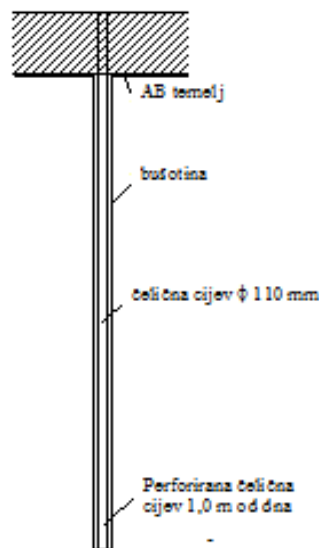
Slika 6.11. Skica temelja, bušotine i čelične cijevi
