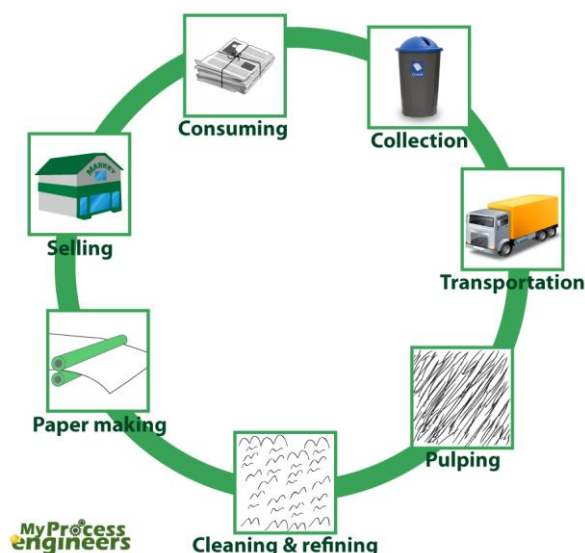
Slika 3.3: Proces recikliranja papira
