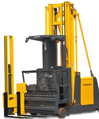
Slika 7. Viličar sa zakretnim vilicama marke Jungheinrich
