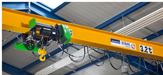
Slika 19. Jednogredni mosni granik marke STAHL
