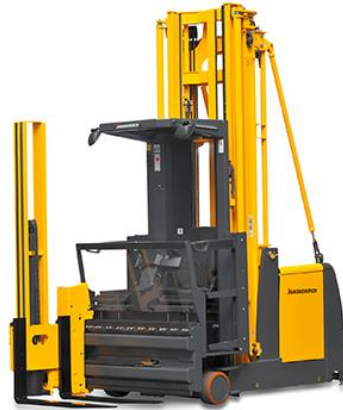
Slika 7. Viličar sa zakretnim vilicama marke Jungheinrich
