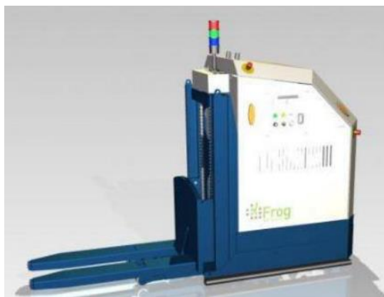
Slika 35. Paletno AGV vozilo
