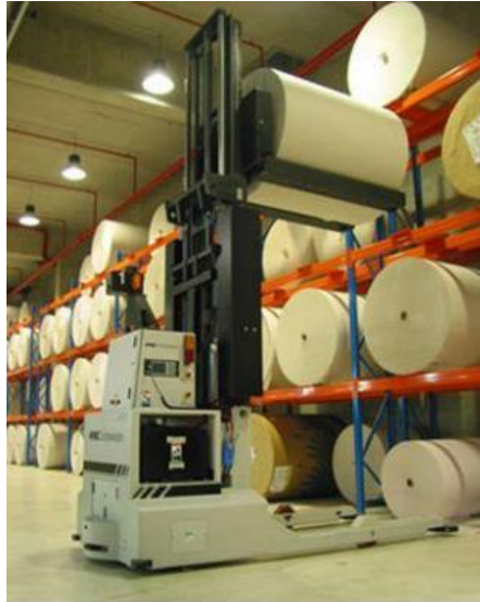
Slika 37. AGV vozilo (viličar) u procesu uskladištenja papira
