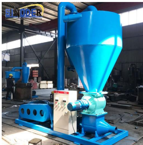
Slika 31. Pneumatski konvejer (elevator) za žitarice
