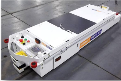
Slika 34. AGV vozilo jediničnih tereta
