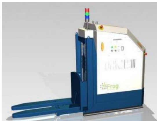
Slika 35. Paletno AGV vozilo
