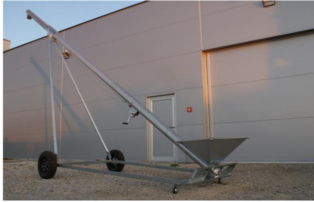
Slika 30. Elevator za žitarice
