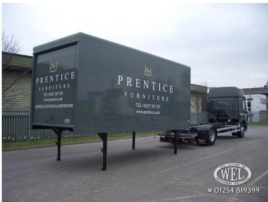
Slika 10. Huckepack tehnologija C [9]
