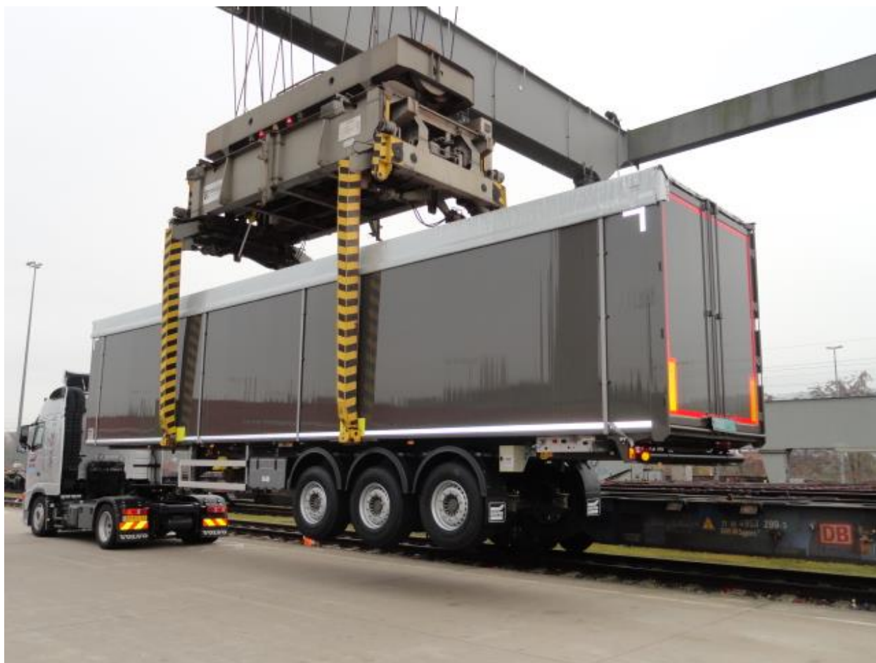
Slika 9. Vertikalni ukrcaj poluprikolice kod Huckepack tehnologije B [8]
