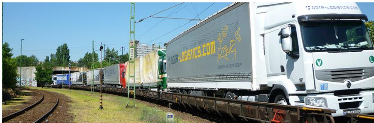
Slika 8. Huckepack tehnologija A
