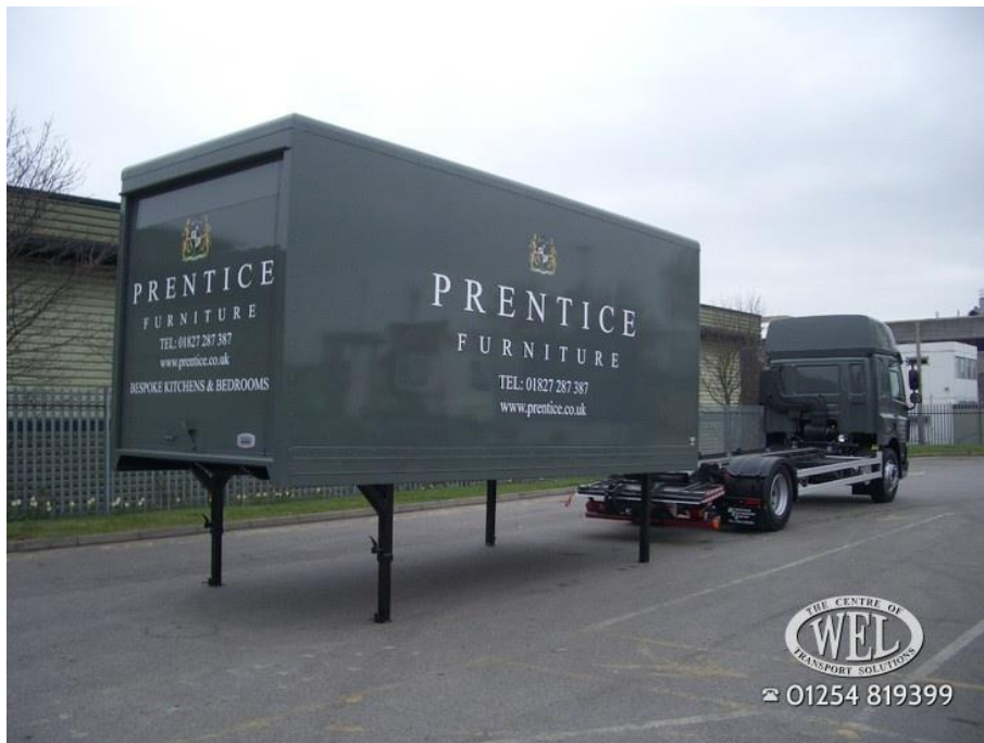
Slika 10. Huckepack tehnologija C [9]
