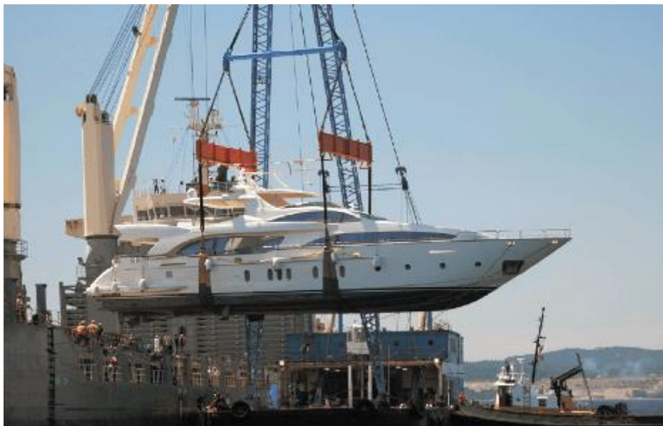
Slika 6. Prikaz tehnologije LO-LO sustava [6]
