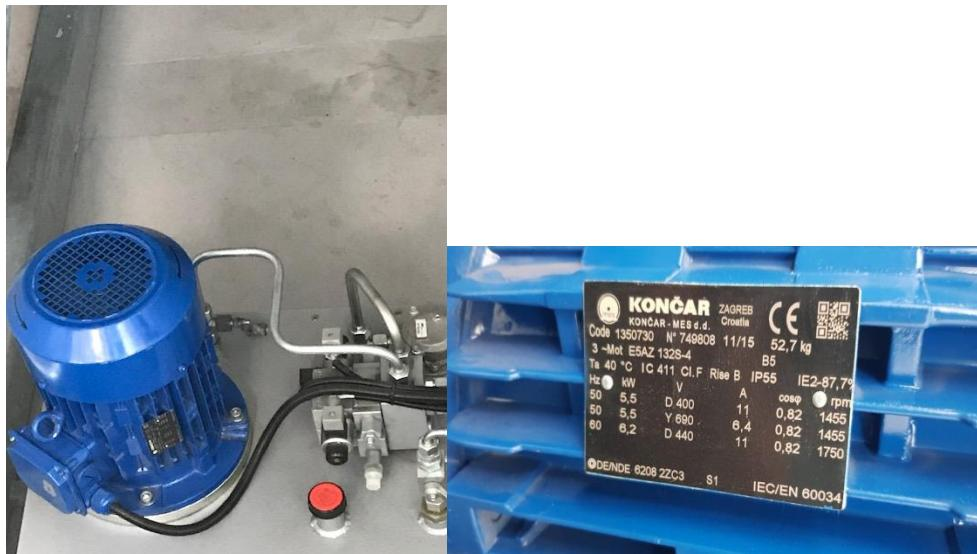
*Slika 4.2 Elektromotor za pogon škaraste platforme*
