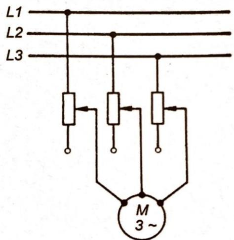
Slika 3.5 Shematski prikaz pokretanja pomoću statorskog pokretača [2]
