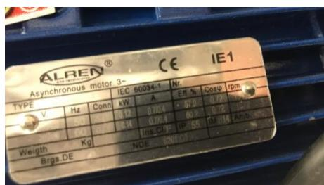
*Slika 4.6 Natpisna pločica asinkronog motora ulaznog transportera*
