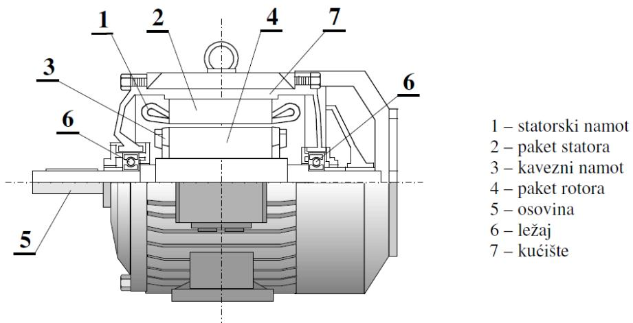
Slika 2.1 Uzdužni presjek gornjeg dijela asinkronog kaveznog motora[4]
