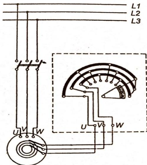
*Slika 3.9 Pokretanje kolutnog asinkronog motora pomoću pokretača [2]*
