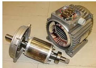
*Slika 2.5 Primjer asinkronoga motora s kaveznim rotorom [6]*
