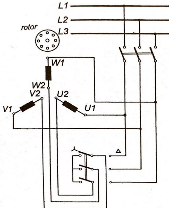
Slika 3.4 Pokretanje kavezognog motora sklopkom zvijezda-trokat [2]
