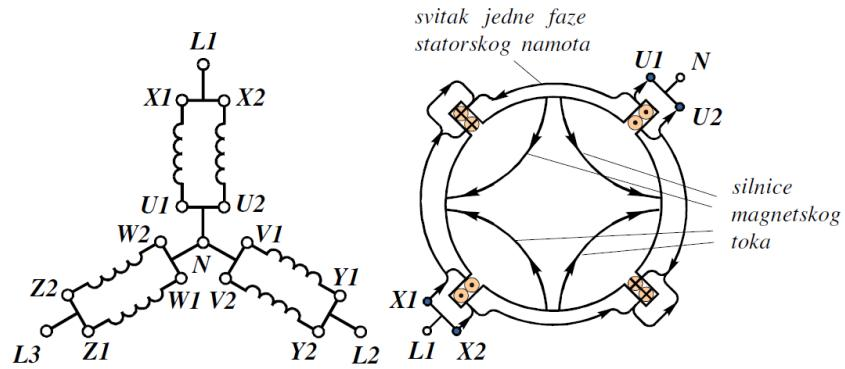
Slika 4.10 Dahlnderov spoj za 4-polni namot, spoj zvijezda, prikaz jedne faze namota i magnetskog toka[4]
