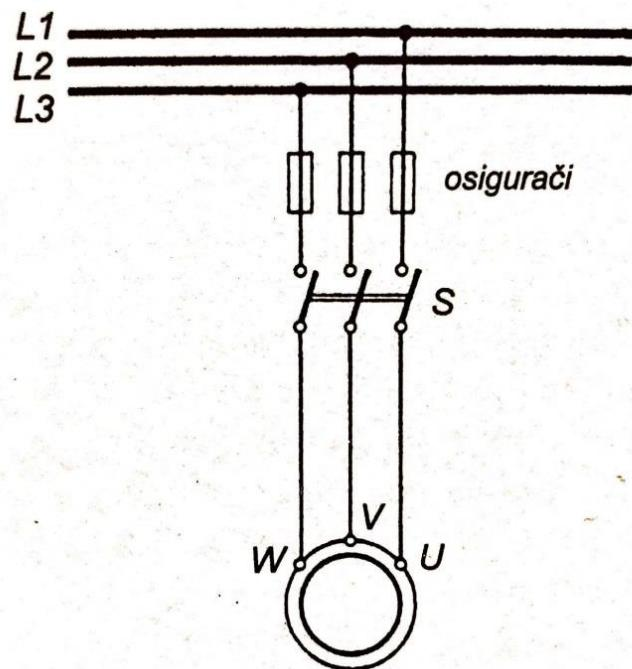
*Slika 3.2 Shema spoja izravnog priključka motora na mrežu [2]*
