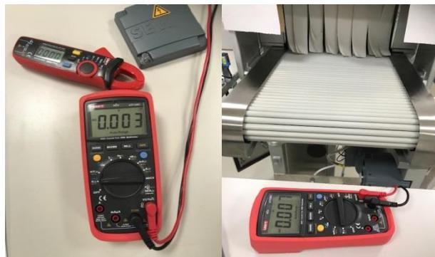
*Slika 4.7 Mjerni instrument digitalni multimetar i strujna kliješta marke LINI-T*
