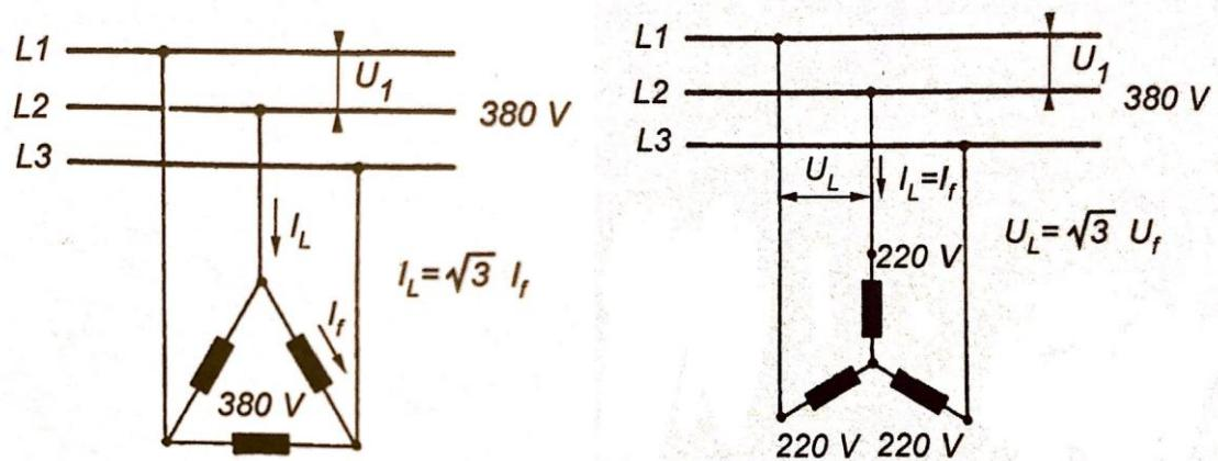
Slika 3.3 Priklučak kavezognog motora na mrežu, spoj statorskog namota u trokut i spoj zvijezda [2]
