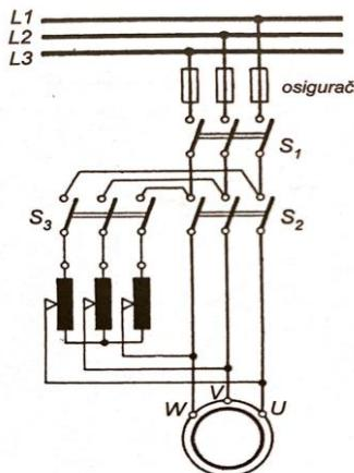
Slika 3.8 Pokretanje pomoću transformatora u štednom spoju [2]
