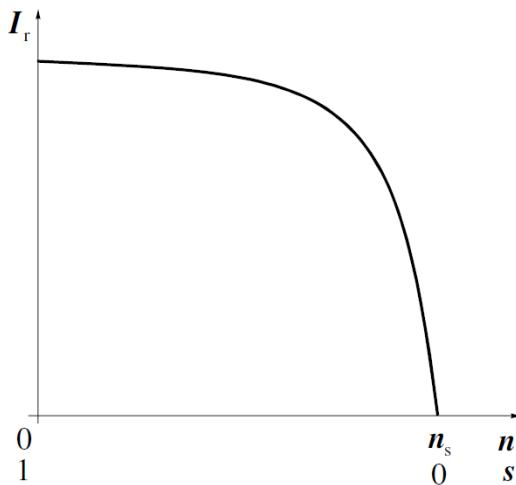
Slika 3.1 Karakteristika struje rotora asinkronog motora [4]
