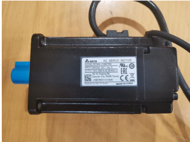
Slika 3.5 Servo motor s natpisnom pločicom
