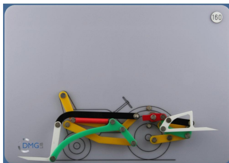
Slika 2.12.: Priključak za poljoprivredni traktor (2) [11]
