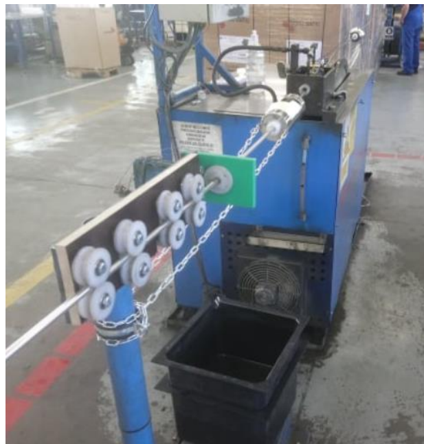
Slika 30 Postupak kalibriranja cijevi
