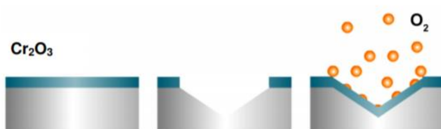
Slika 1 Prikaz mehanizma samoobnavljanja pasivnog filma kromovih oksida na površini [2]
