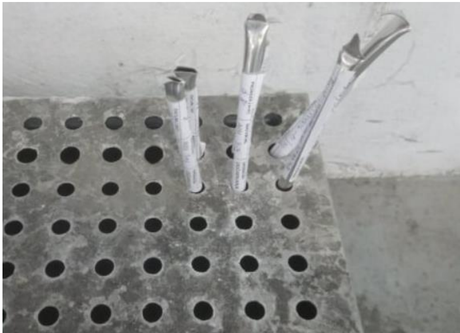
Slika 37 Ispitivanje cijevi u vodenoj otopini natrijevog klorida
