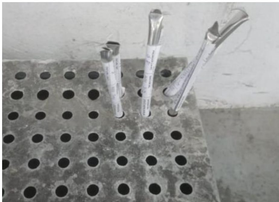
Slika 37 Ispitivanje cijevi u vodenoj otopini natrijevog klorida
