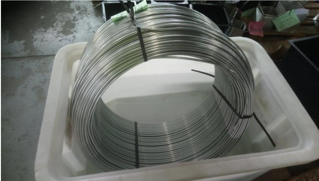
Slika 39 Ispitivanje koluta cijevi u vodi
