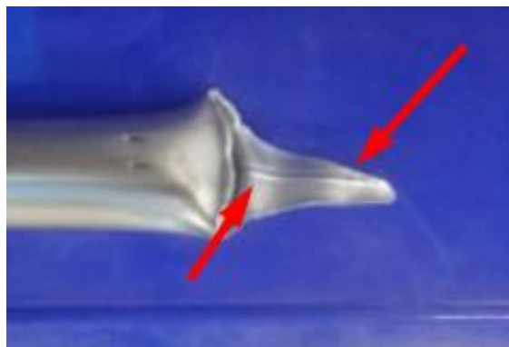
Slika 35 Vizualna kontrola zavora nakon kalibriranja i toplinske obrade
