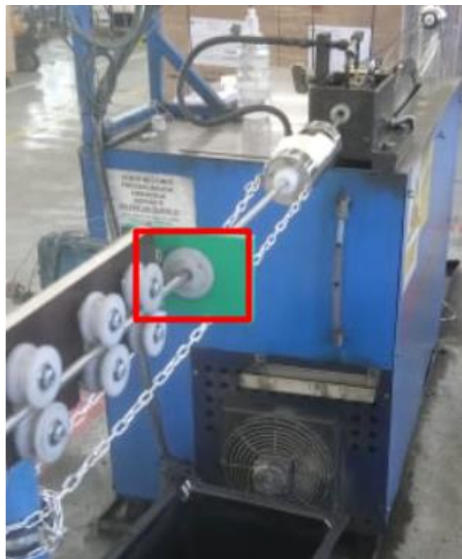
Slika 33 Kontrola od pukotina prije kalibriranja
