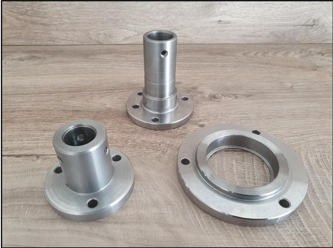
*Slika 4.20 Dijelovi nakon tokarenja*
