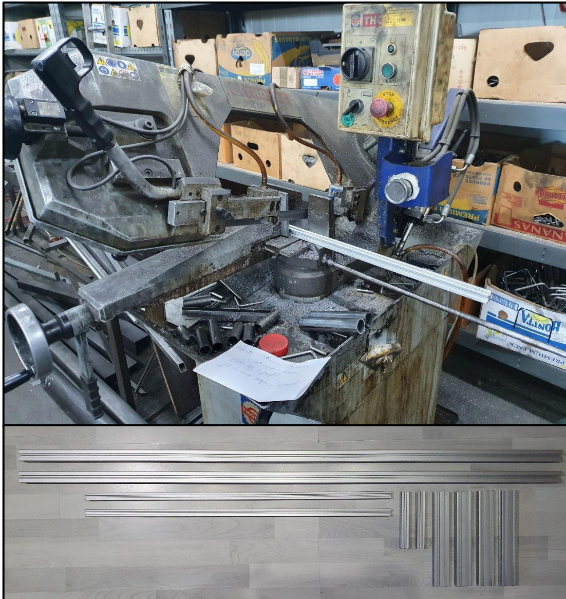
Slika 4.17 Rezanje aluminijskih profila
