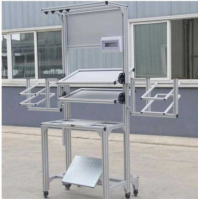
*Slika 4.8 Primjer upotrebe strukturnih aluminijskih profila*
