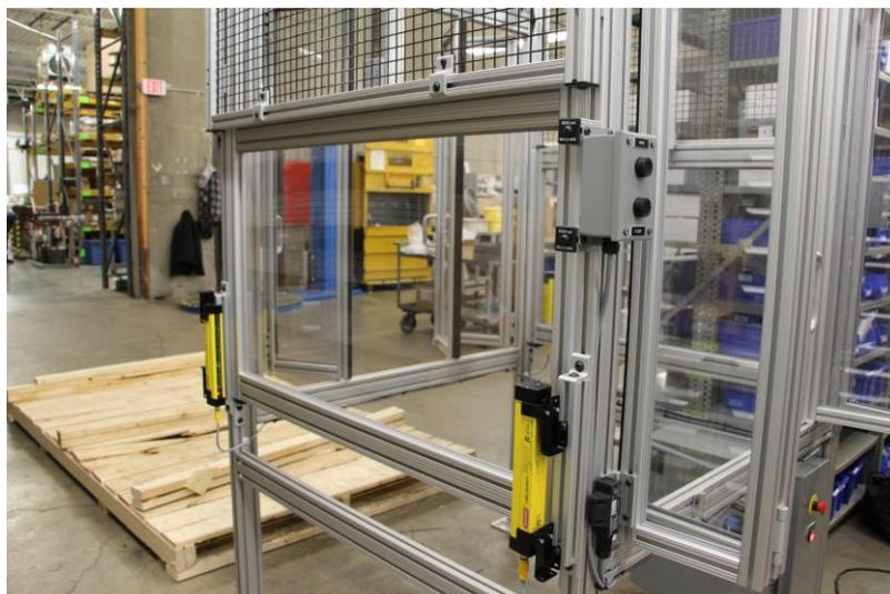
*Slika 4.9 Primjer upotrebe strukturnih aluminijskih profila u proizvodnom pogonu*
