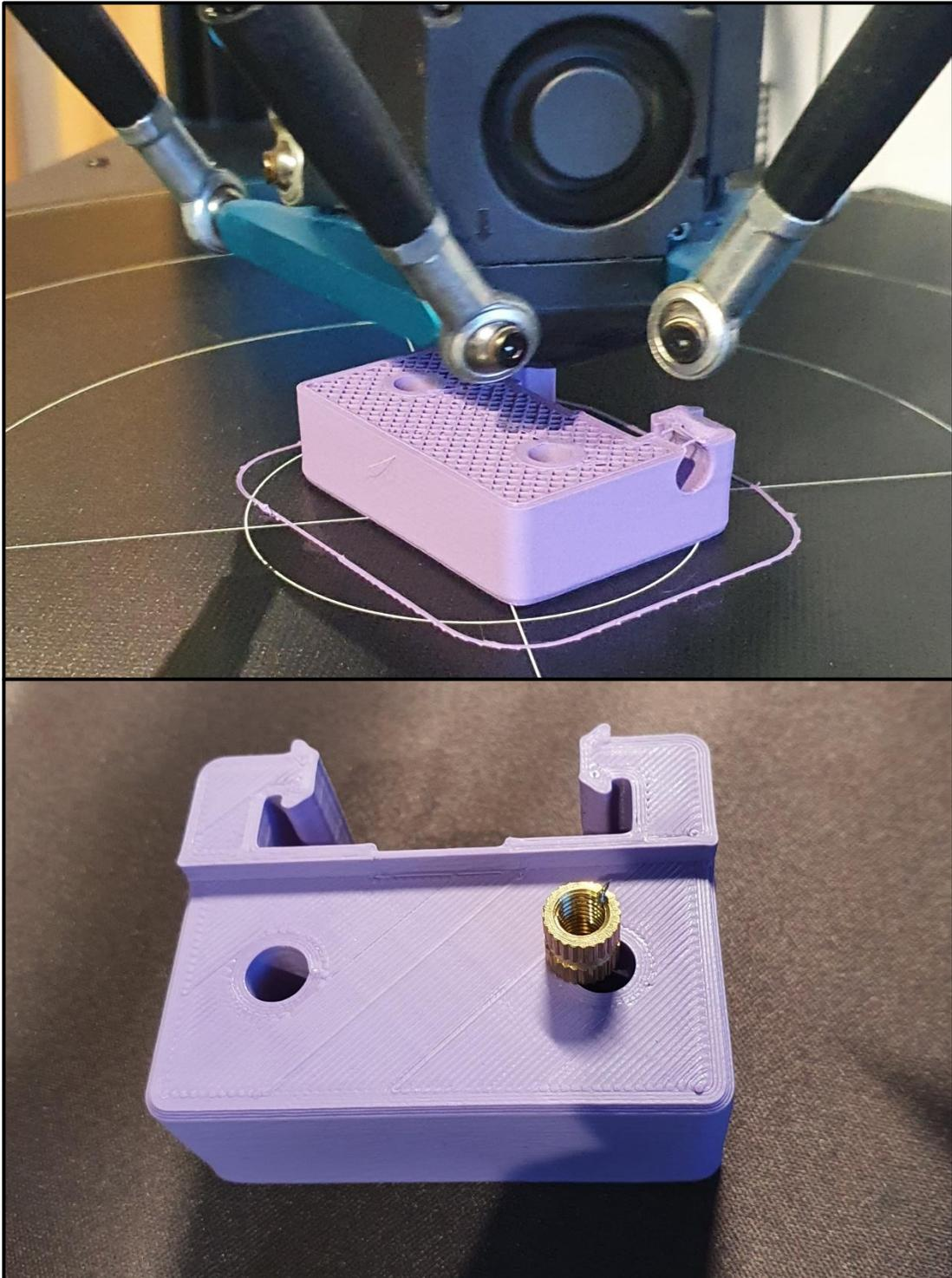
*Slika 4.22 Printanje na 3D printeru i utiskivanje matice*
