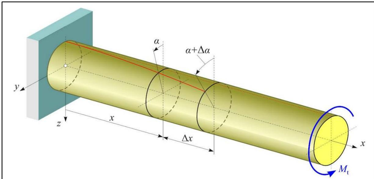
Slika 2.2 Kut uvijanja dva infinitezimalno bliska presjeka
