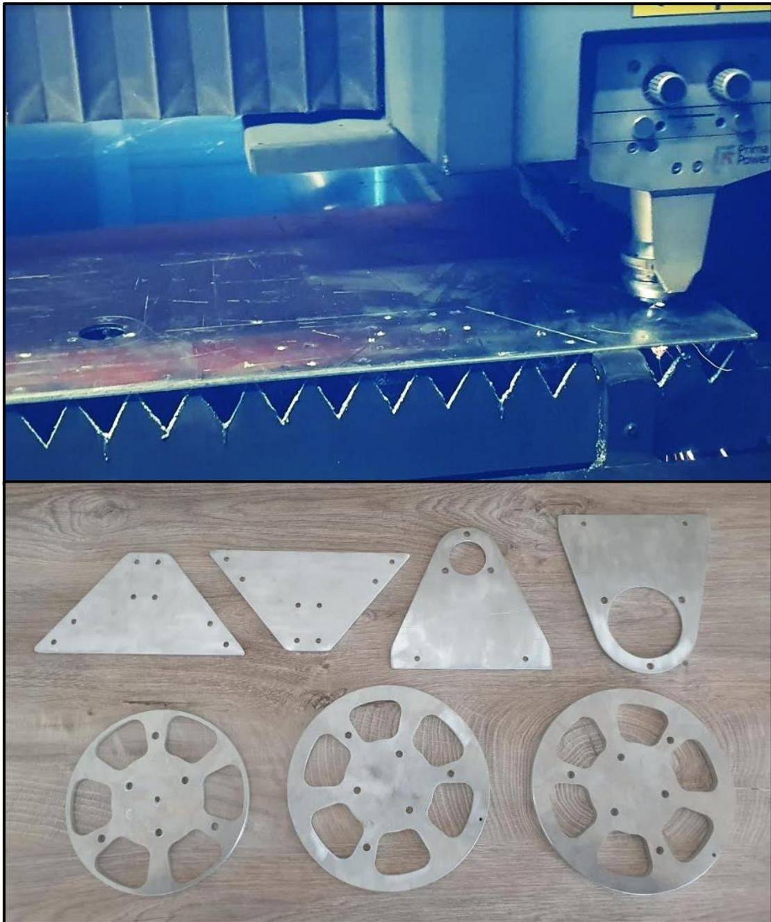
*Slika 4.18 Rezanje na laseru i izrezane aluminijske pozicije*
