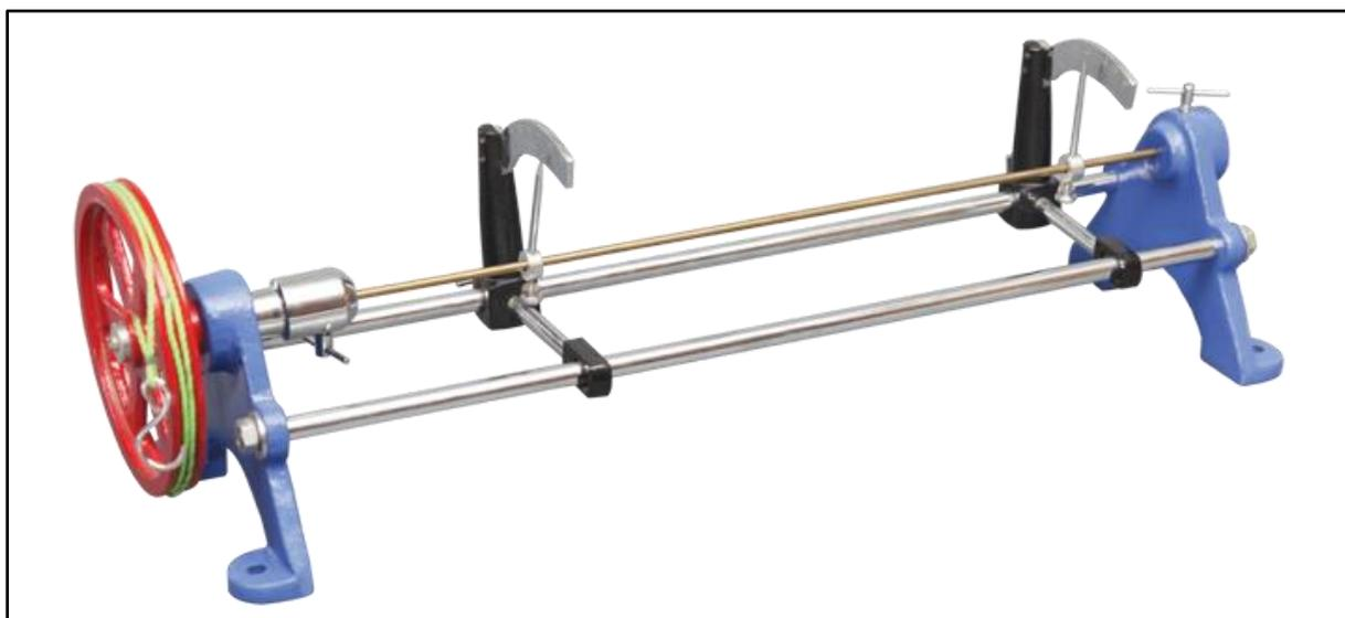
*Slika 1.1 Komercijalna naprava za test uvijanja*
