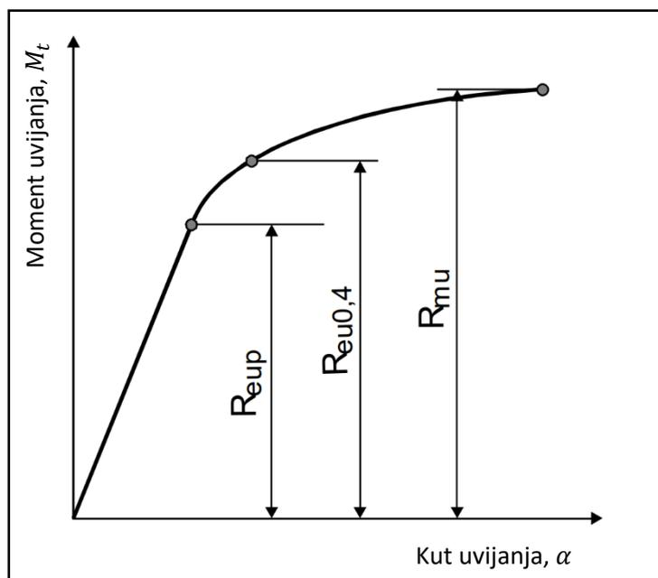
Slika 3.2 Dijagram uvijanja „Moment uvijanja – Kut uvijanja“
