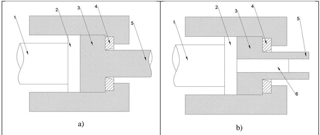
*Slika 4.6 Postupak istiskivanja punog i šupljeg profila*
