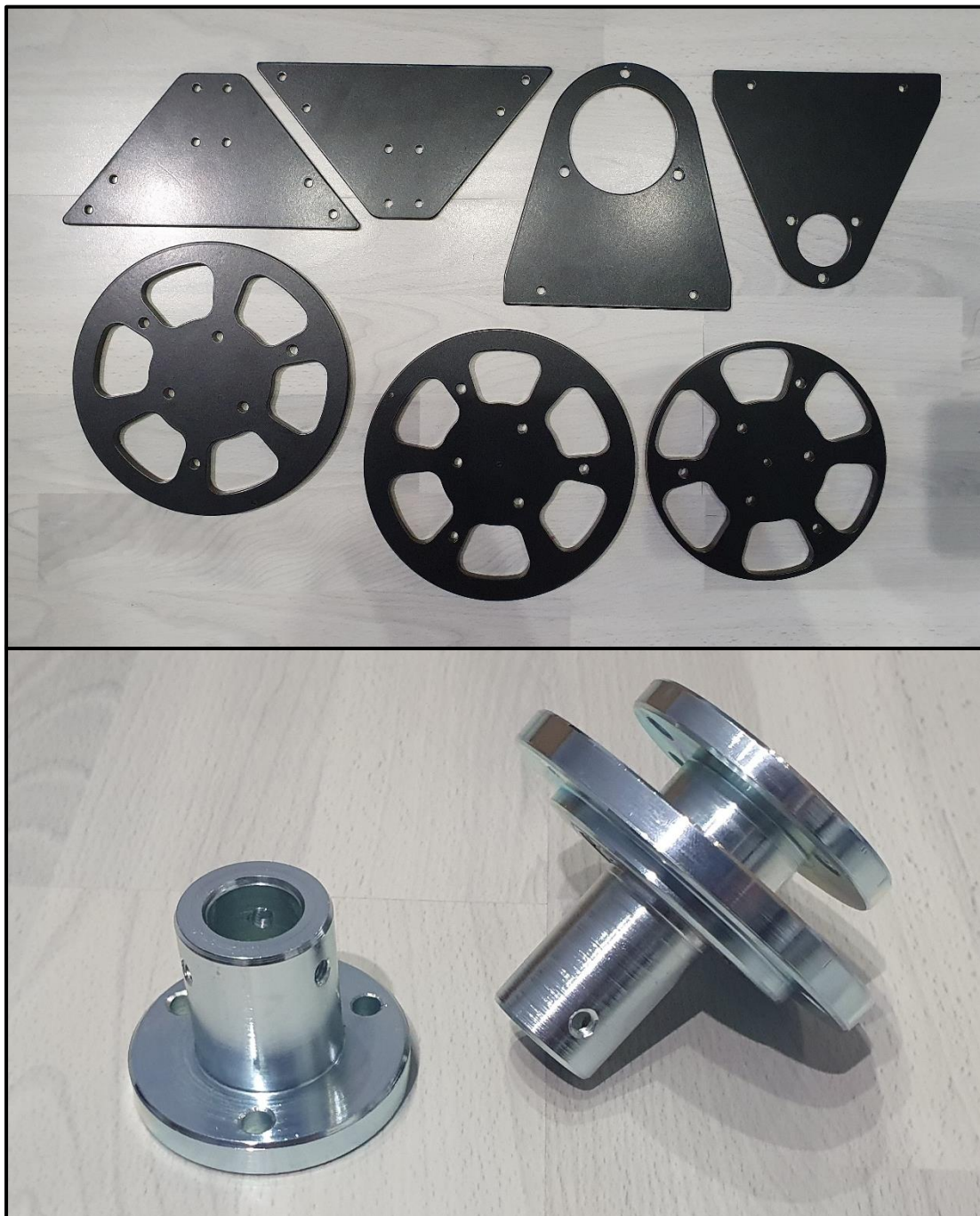
Slika 4.21 Plastificirani i pocinčani dijelovi
