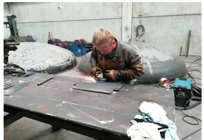
Slike 9.11. i 9.12. Međuslojno čišćenje brušenjem
