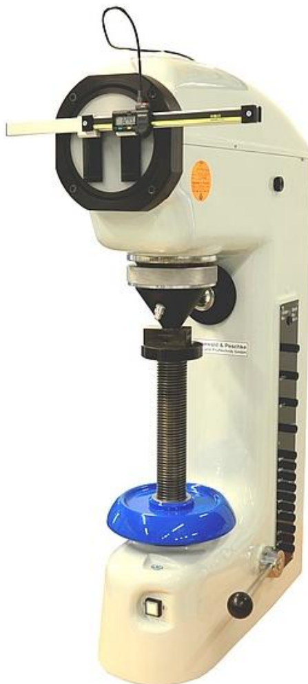
Slika 11.16. Uređaj za mjerenje tvrdoće (tvrdomjer) HPO-250[19]
