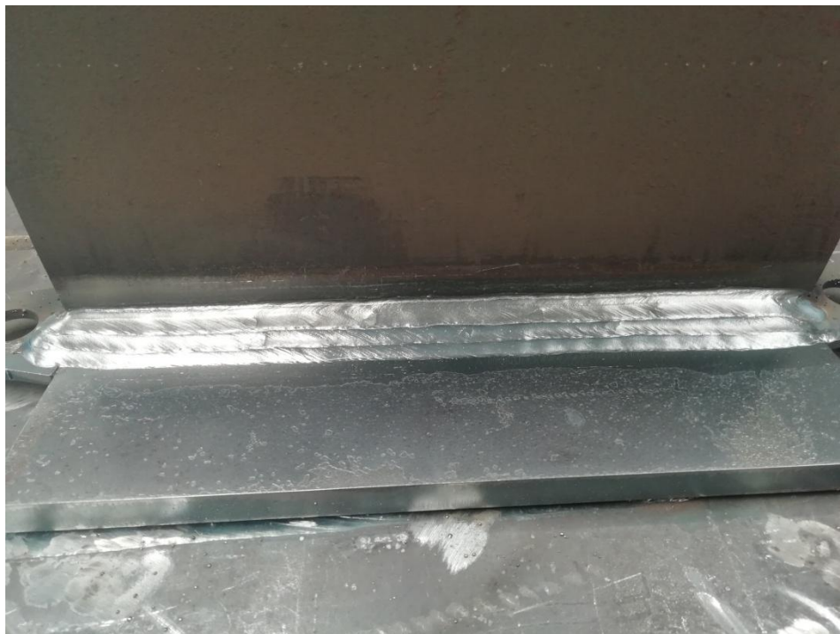
Slika 9.8. Zavaren ispitni uzorak kutnog spoja
