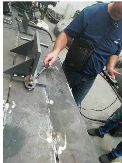
Slike 9.9. i 9.10. Mjerenje međuprolazne temperature
